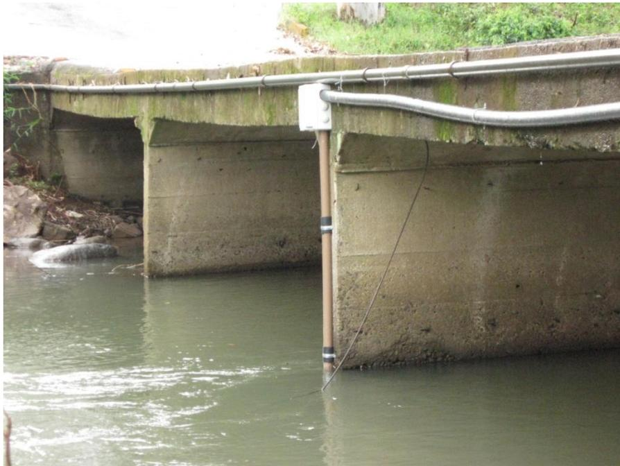
Figura 7 – Foto da estrutura de instalação do sensor de nível de São Vendelino
