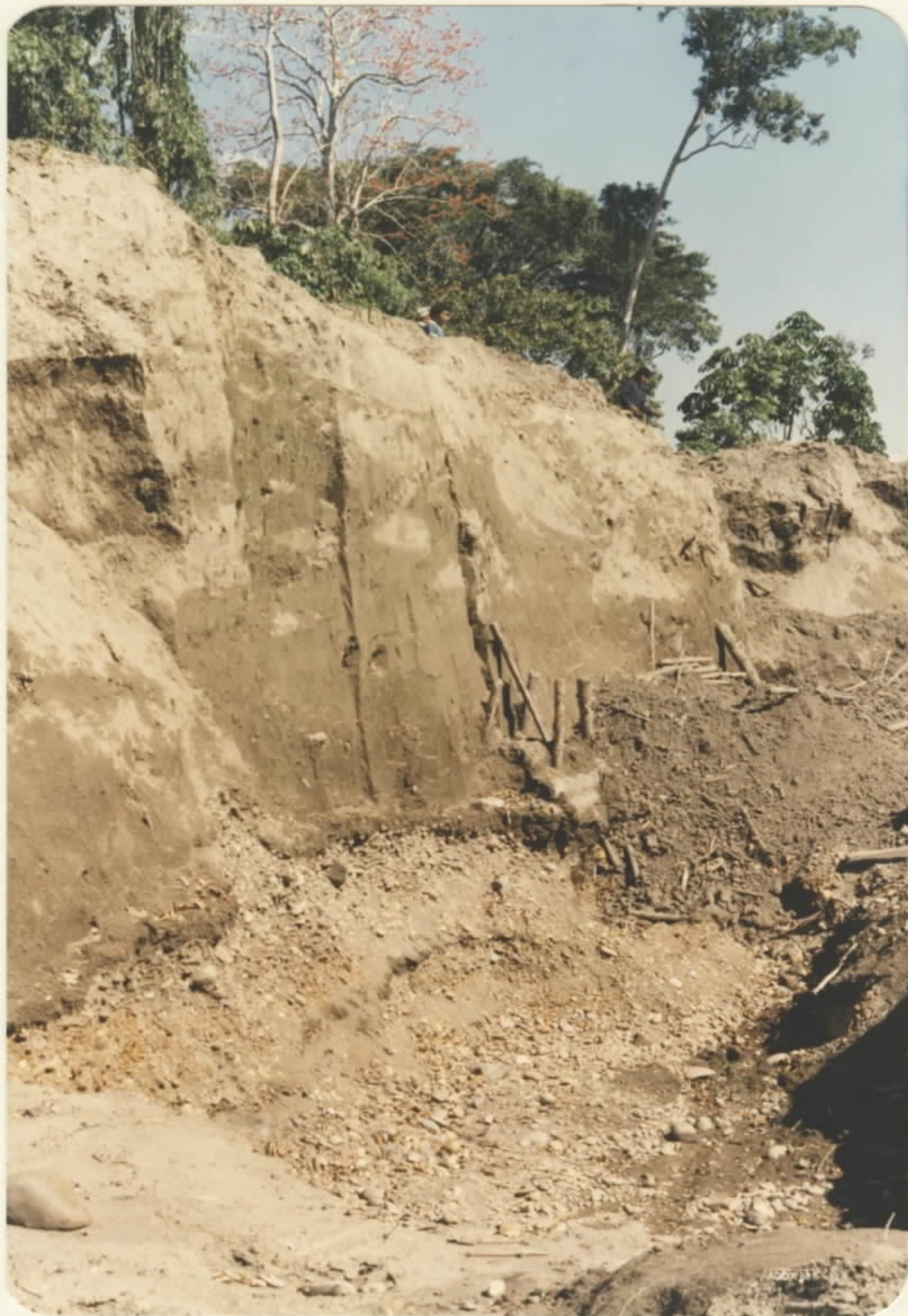
Foto 12 - Aspecto de garimpo situado nos limites da área e algo afastado da margem do rio. Notar a espessura da cobertura siltica e o contato brusco com o cascalho.
