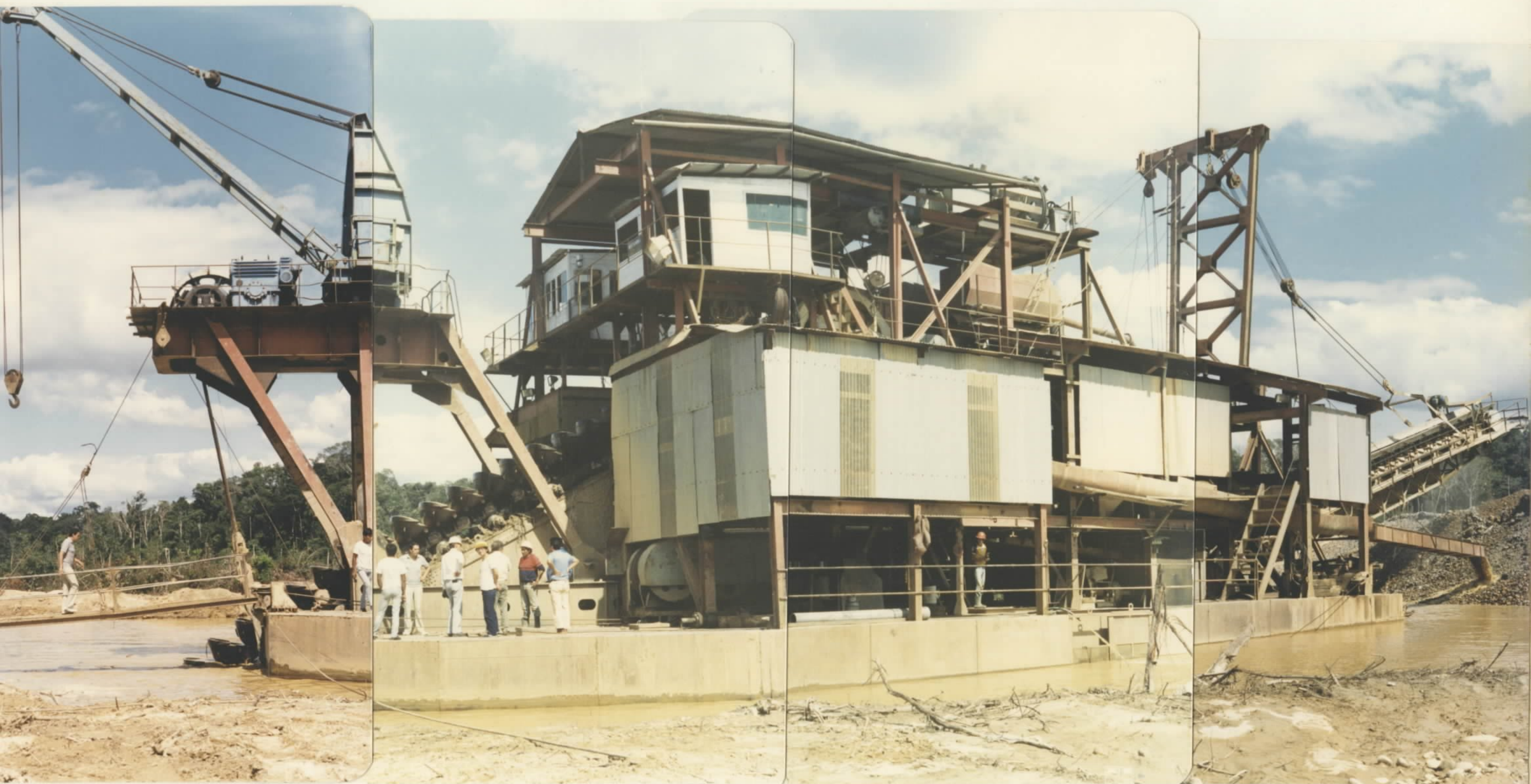
Foto 6 - Vista da draga da foto anterior, com capacidade para 130.000 m 3 /mês.
