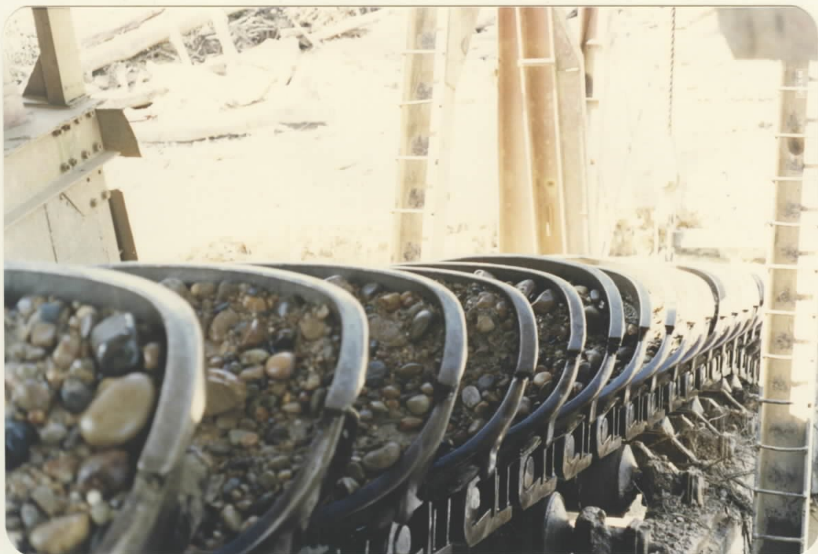
Foto 7 - Detalhe da alimentação da draga por caçambas em Alcatruz, destacando a granulometria avantajada mi- nério.
