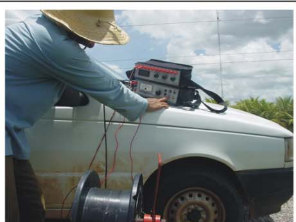
Leitura do valor de resistividade aparente referente ao Perfil de Resistividade CD. Equipamento exibido em detalhe.
