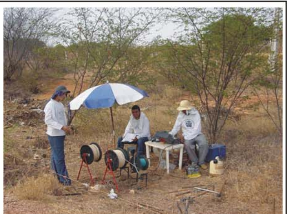
Fotografia exibindo em detalhe o centro da SEV 02, onde observa-se o Eletroresistivímetro, as bobinas referentes aos eletrodos AB e MN, além de outros objetos utilizados na realização das sondagens.
