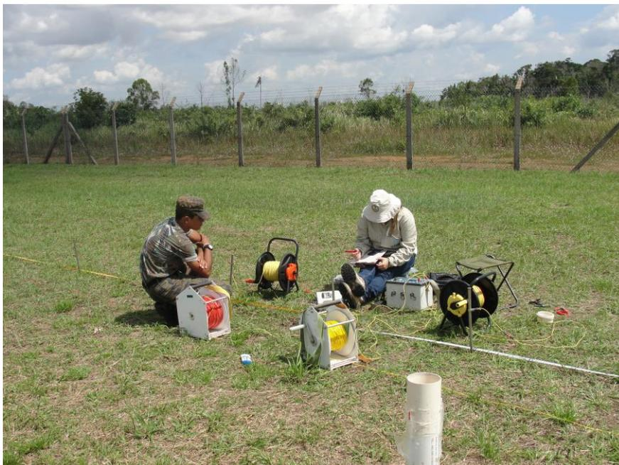
Foto 02 – Técnico executando as leituras de resistividade aparente do solo
