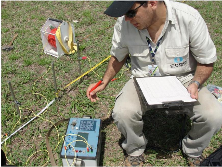
Foto 01 – Equipamento Eletroresistivímetro 10 canais
