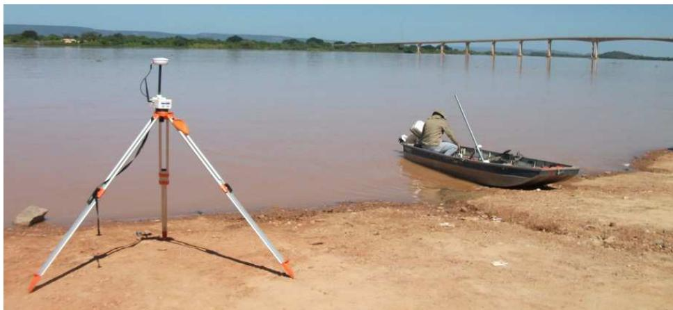
Cada medição acústica foi constituída por um conjunto de pelo menos cinco travessias ao longo da seção transversal do rio. O valor da vazão foi determinado com base na média dos resultados obtidos em cada travessia.
