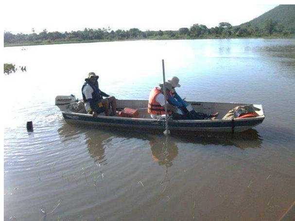
Além dos equipamentos instalados na embarcação, durante as medições acústicas foi utilizado GPS Geodésico, com Sistema RTK – “*Real Time Kinematic*”, instalado na margem dos rios, para transmissão de correção de coordenadas em tempo real, e correção das coordenadas obtidas com o GPS da embarcação, procedendo com a determinação da velocidade de deslocamento do barco durante as travessias.
