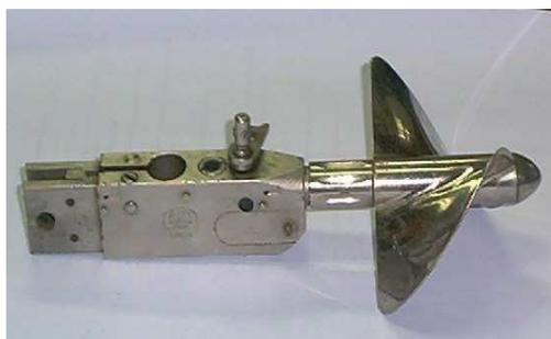
a) Molinete de Eixo Horizontal com Hélice.
