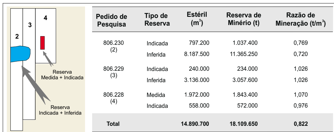
Figura 6 - Localização das mineralizações e relação de mineração ( \text{m}^3/\text{t} )
