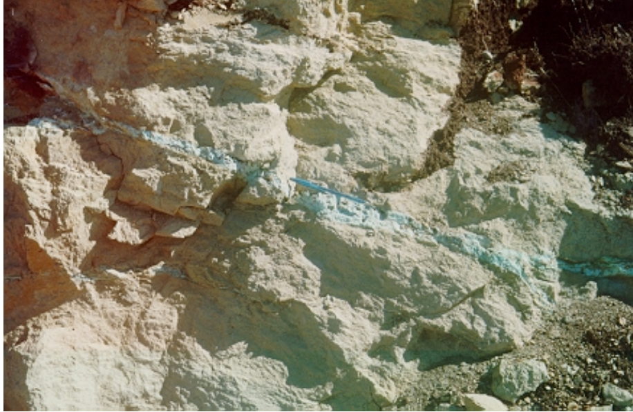
Foto 11 - Serpentinito maciço intercalado por vênulas de garnierita. Corte em estrada do Morro Sem Boné, ponto NN 05.
