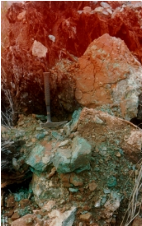
Foto 5 - Blocos de garnierita (provavelmente bolsões) em serpentinito alterado. Morro do Leme 1, ponto NN 5855.
