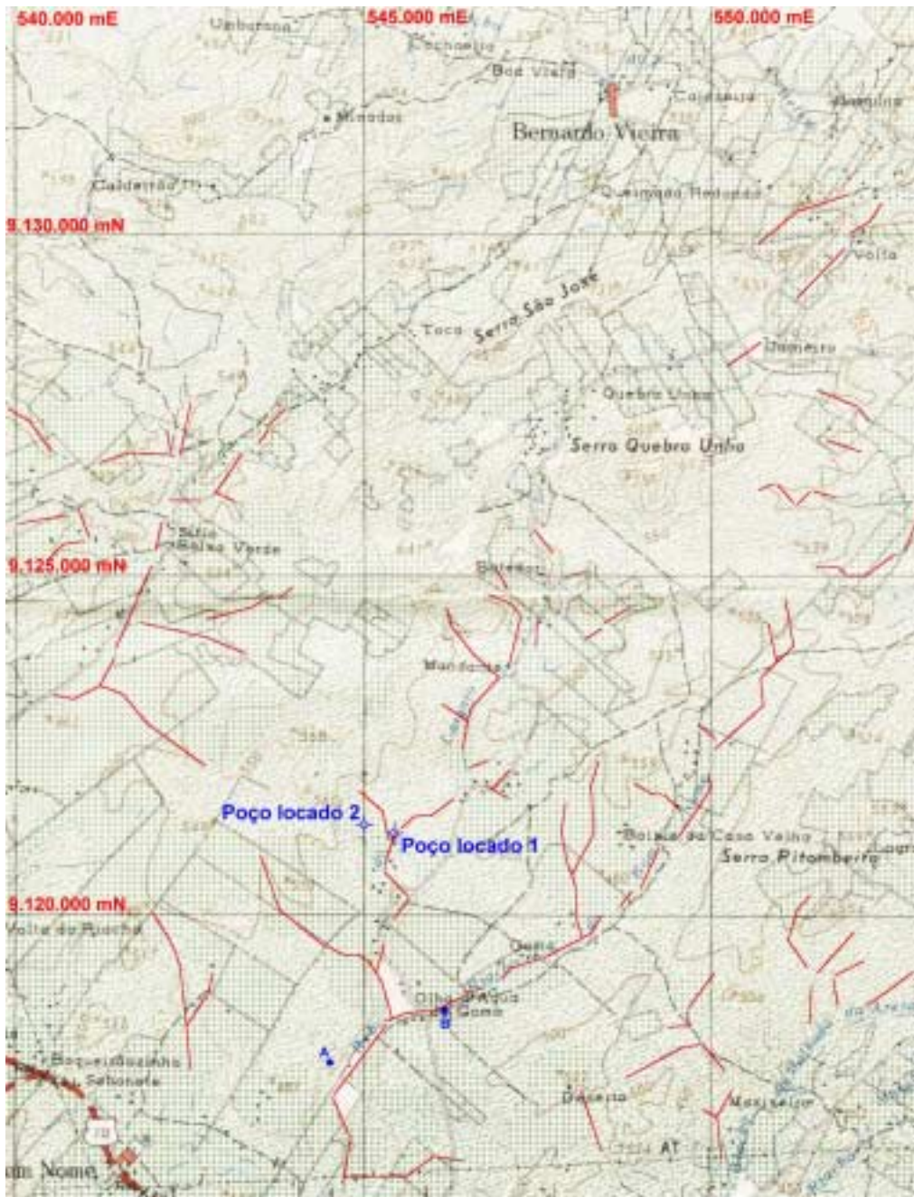
Figura 4 - Locações dos poços para abastecimento dos distritos Bernardo Vieira, Santa Rita e Luanda, com devida interpretação de fraturas pelo padrão de drenagem em planta plani-altimétrica da SUDENE, Folha SB.24-Z-C-IV (São José do Belmonte).
