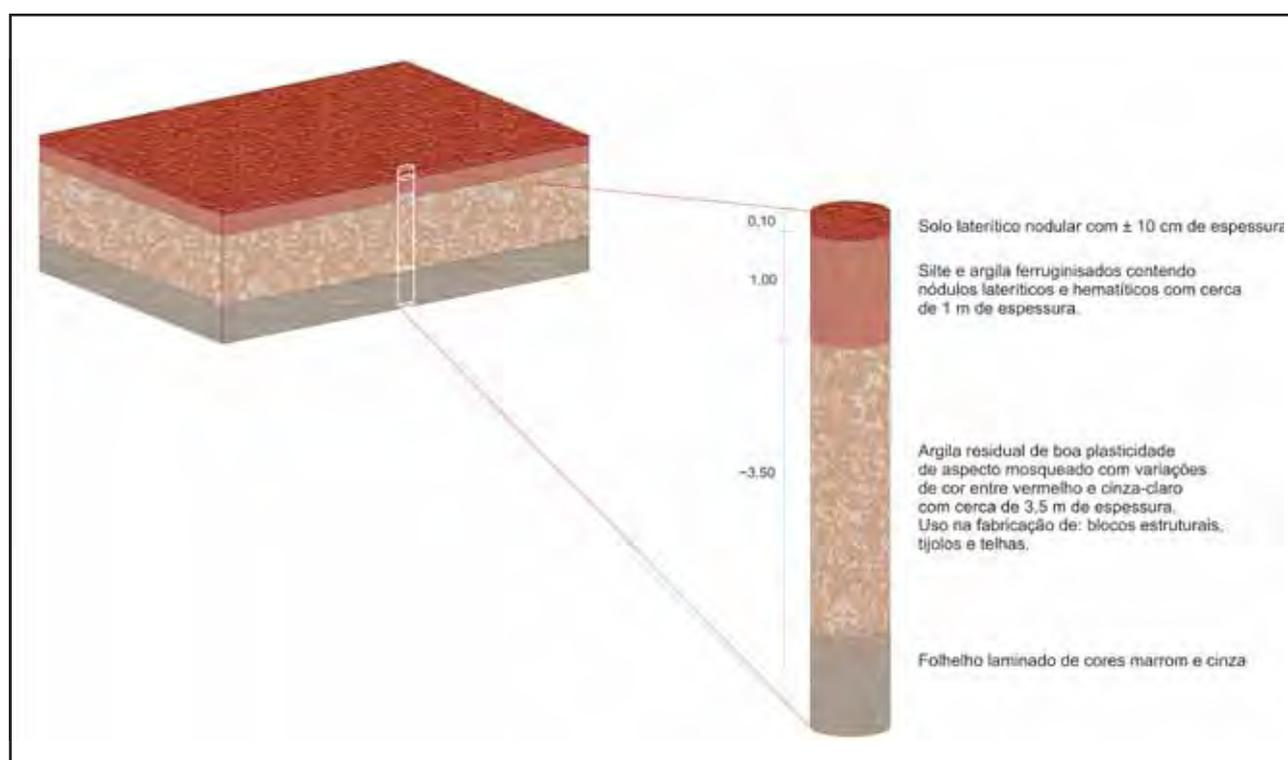
Figura 14 – bloco diagrama e projeção do perfil em 3D do furo de sondagem, mostrando as camadas referentes ao ALVO I.
