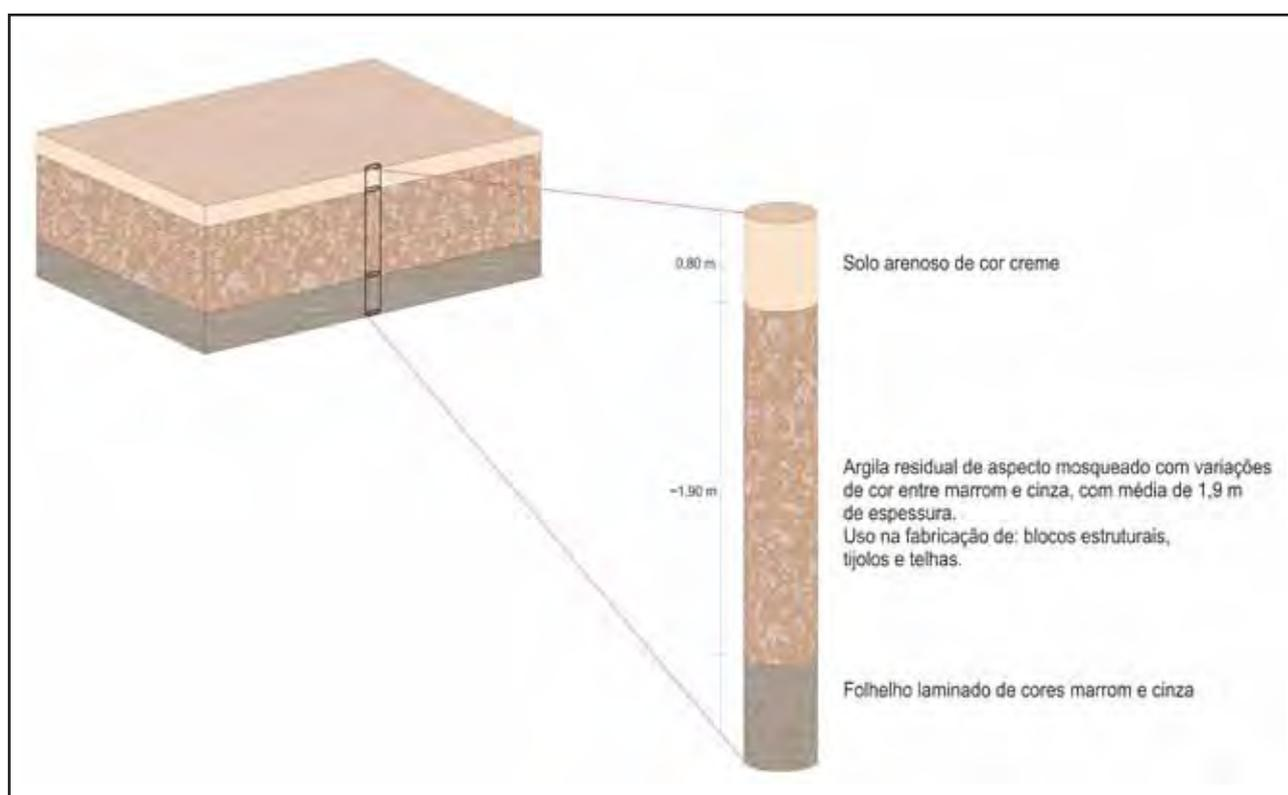
Figura 17 – Bloco diagrama e o perfil do furo de sondagem, mostrando o empilhamento das camadas do ALVO IV.
