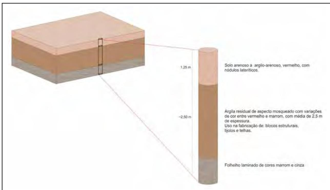
Figura 16 – Bloco diagrama e projeção do perfil 3D do furo de sondagem, mostrando a distribuição das camadas do ALVO III.
