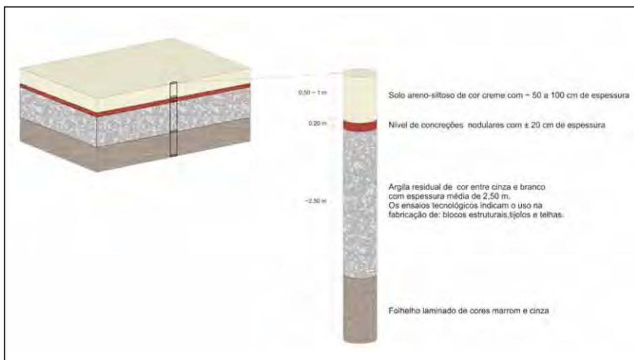
Figura 15 – Bloco diagrama e perfil 3D de furo de sondagem, mostrando distribuição das camadas do ALVO II.
