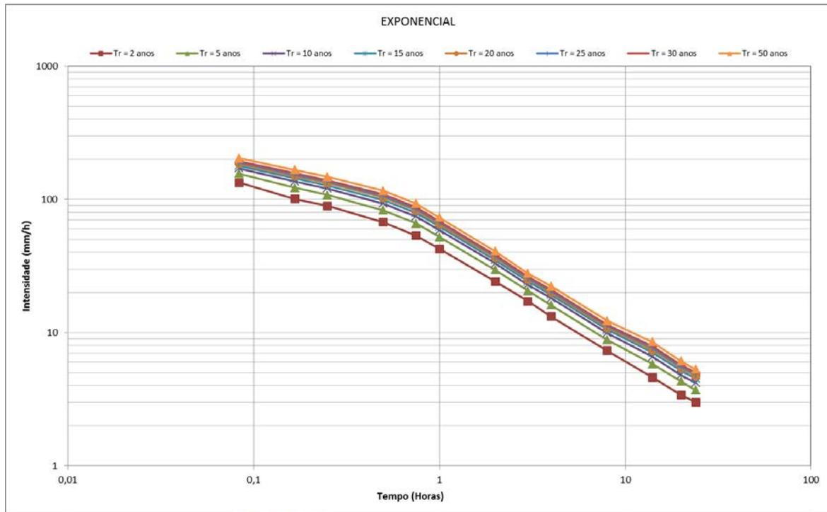
Figura 02 – Curvas intensidade-duração-frequência
