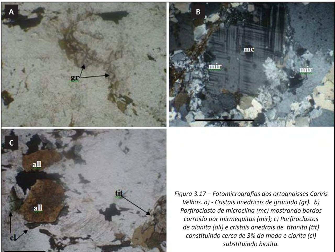
Figura 3.17 – Fotomicrografias dos ortognaisses Cariris Velhos. a) - Cristais anedricos de granada (gr). b) Porfiroclasto de microclina (mc) mostrando bordos corroído por mirmequitas (mir); c) Porfiroclastos de alanita (all) e cristais anedrais de titanita (tit) constituindo cerca de 3% da moda e clorita (cl) substituindo biotita.
