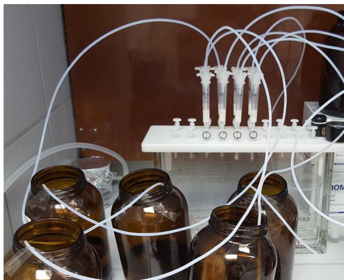
Figura 16: Sistema de extração em fase sólida em funcionamento, com utilização de um manifold .
