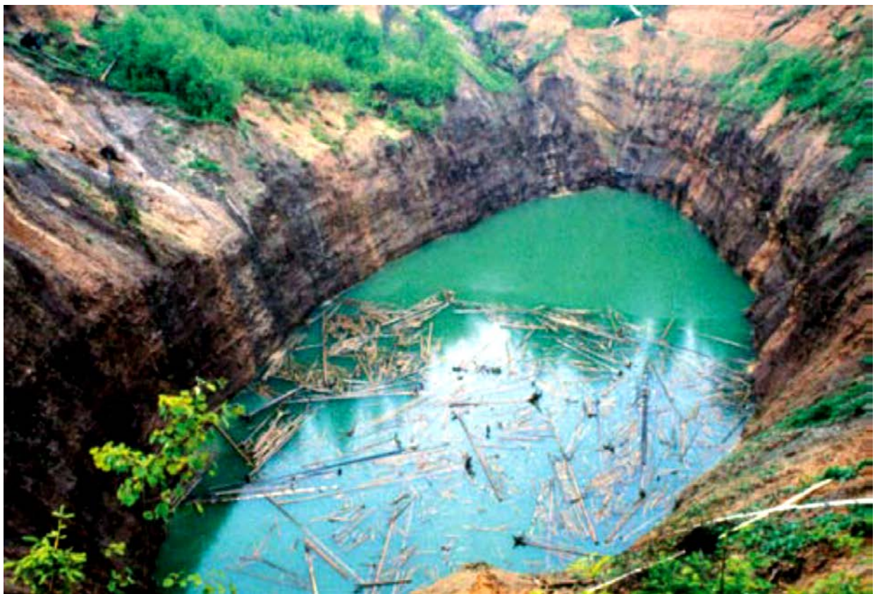
Figura 2.4 – Área Colapsada por exploração de potássio na mina de Berezikovskiy–Rússia.
