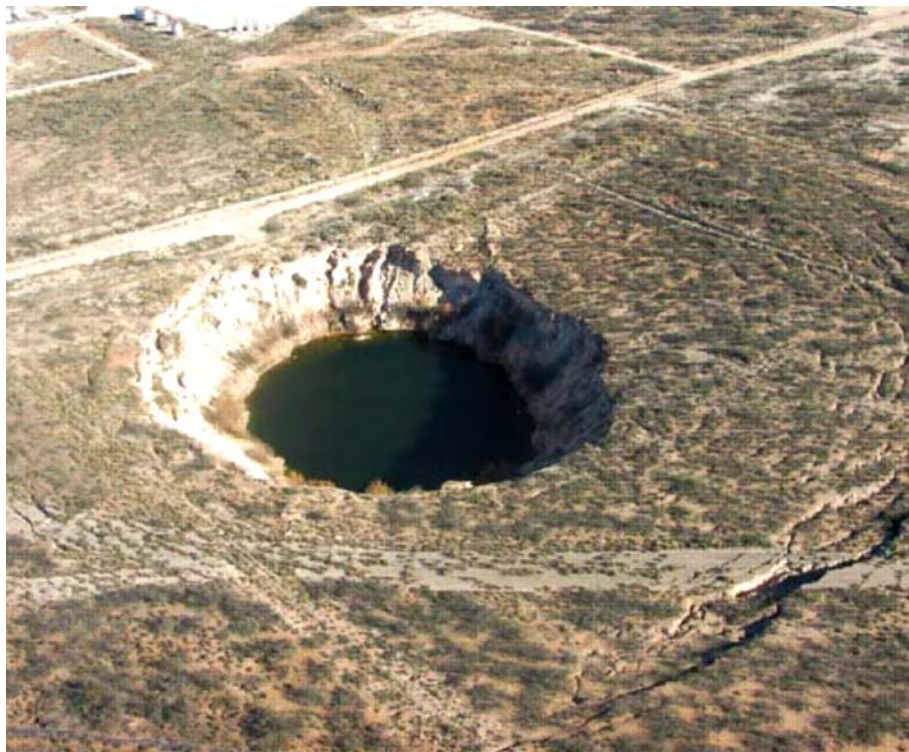
Figura 2.6 – Colapso em sondagem petrolífera, Texas, USA.
