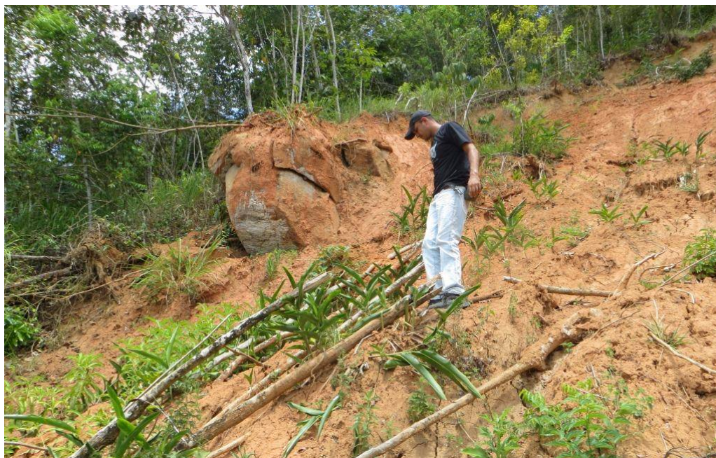
Figura 4 – Vista do “ninho” de blocos. Notar a forma pouco arredondada e as fraturas presentes.
