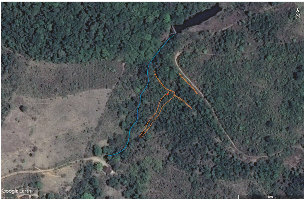
Figura 1 – Imagem aérea indicando a cicatriz de escorregamento e as trincas (laranja), a posição do bloco de rocha (ponto em vermelho) e a drenagem (azul). Notar residência próxima ao eixo do talvegue.
