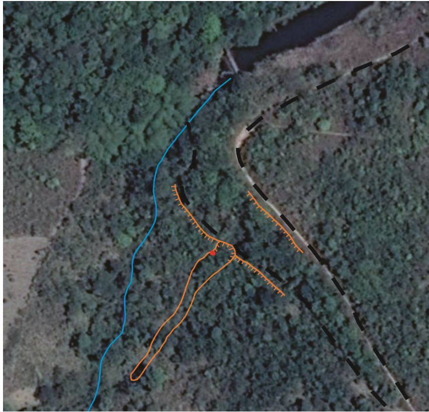
Figura 8 – Imagem aérea indicando a presença de trilha e acesso (preto) laterais às cicatrizes de escorregamento e as trincas (laranja).
