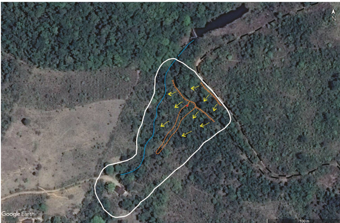
Figura 15 – Em branco a área considerada de exclusão, ou seja, que podem ser atingidas por movimentos de massa e não devem ser construídas residências. A residência presente na área deve manter-se desocupada.
