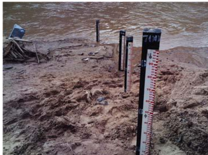
Figura 16 - Réguas da estação fluviométrica de Santana do Mundaú recuperadas após a cheia de junho de 2010. Fonte: CPRM, 2010.
