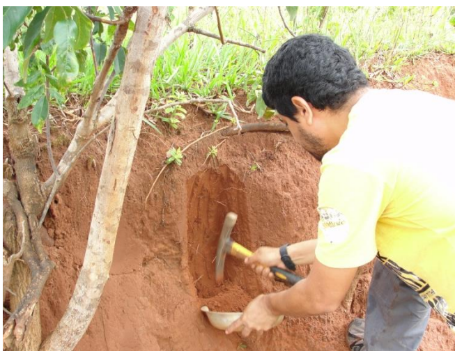
Figura 6 - Procedimento de amostragem de solo
