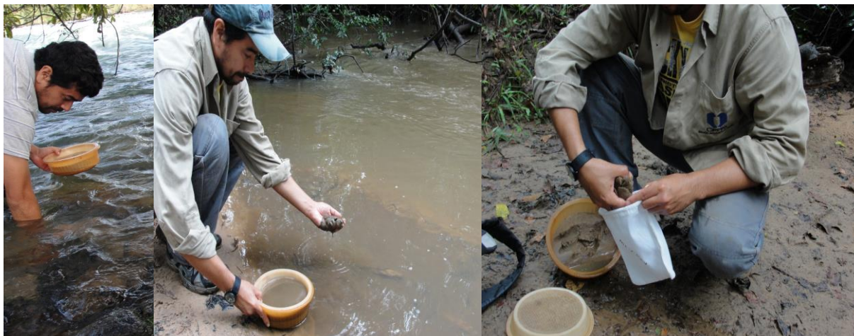
Figura 5 - Procedimento de amostragem de sedimento de corrente
