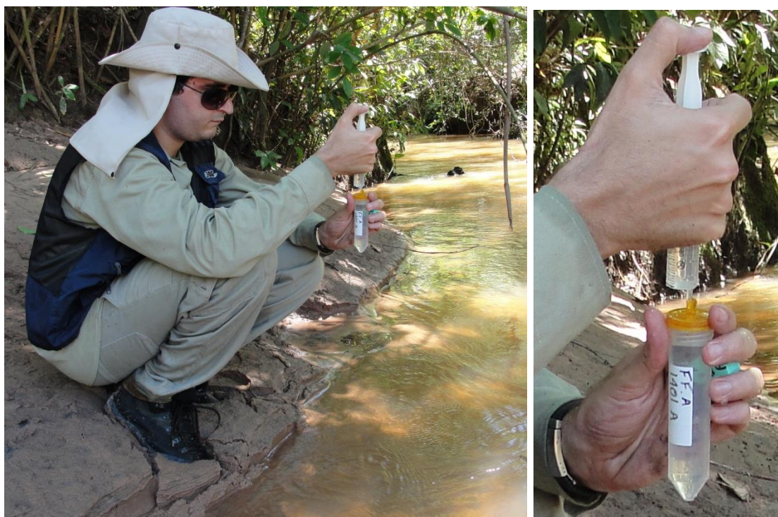
Figura 3 - Procedimento de coleta de amostra de água
