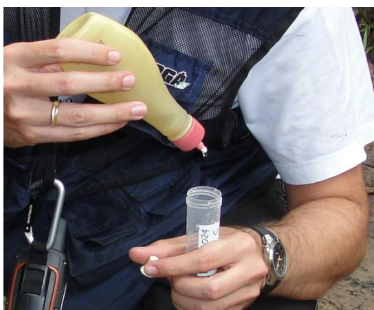
Figura 4 - Acidificação da amostra de água para análise de cátions
