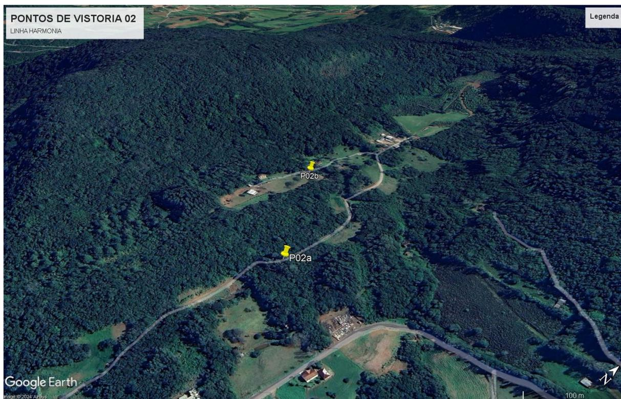
**Figura 6– Ponto P02.** Processo de rastejo instalado em encosta, atingindo vias, com risco remanescente para casas em área rural na Localidade de Linha Harmonia. Imagem Google Earth.
