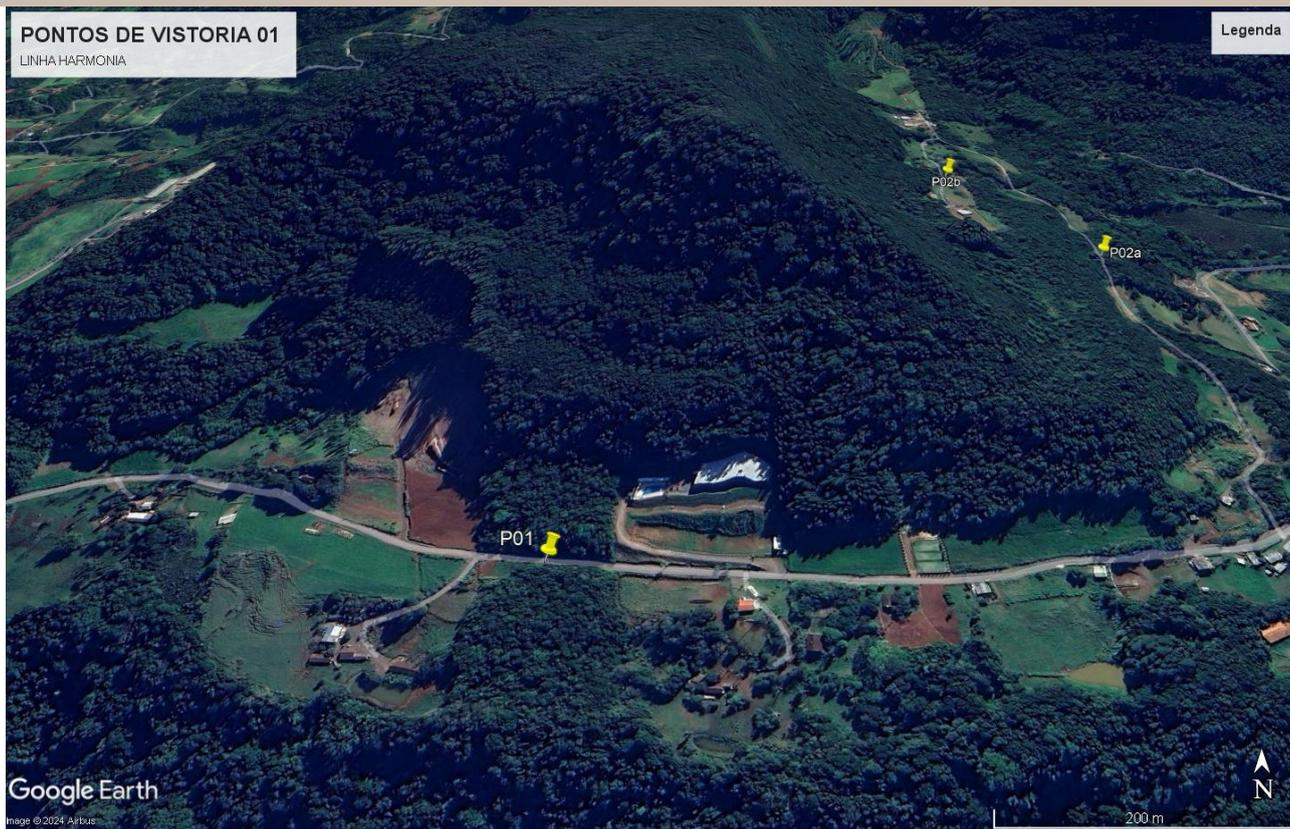
**Figura 3– Ponto P01.** Processo de rastejo instalado em encosta, atingindo vias, com risco remanescente para casas em área rural na Localidade de Linha Harmonia. Imagem Google Earth.
