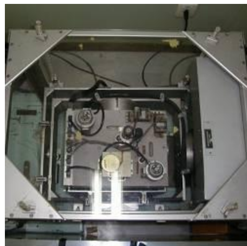
Fig. 3.16 – Gravímetro Shipboard, usado em medidas de gravidade na superfície d'água. (Fonte: http://www.lacosteromberg.com )
