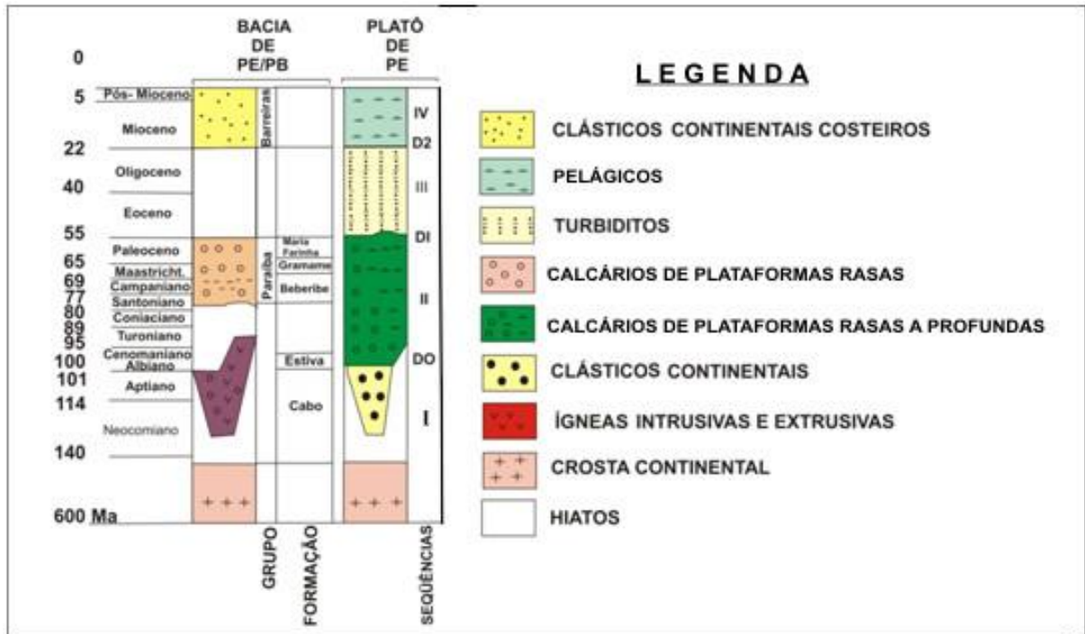
Fig. 4.3- Coluna Estratigráfica proposta para a região do Platô de Pernambuco, segundo Alves & Costa (1986) in de Moraes (2008), com modificações.
