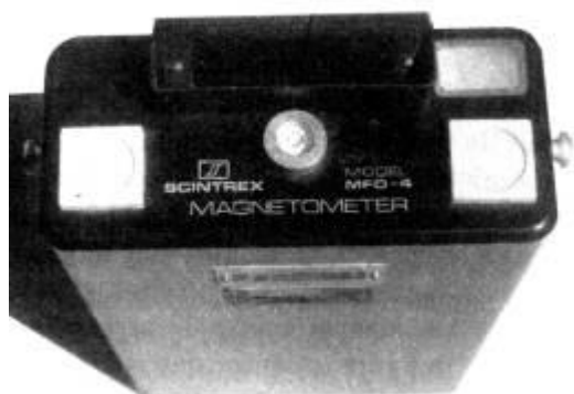
Fig. 4.6 - Magnetômetro de saturação (FLUX-GATE): tem precisão de 1nT e o intervalo de medidas é de aproximadamente 100.000 nT. É comumente utilizado em levantamentos terrestres. Fonte: Luiz & Silva, 1995.
