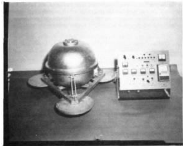
Fig. 3.14 – Gravímetro LaCoste & Römerberg modelo H, submersível, usado em levantamentos aquáticos de fundo. Precisão: 0,01 mgal. (Fonte: Luiz & Silva, 1995)
