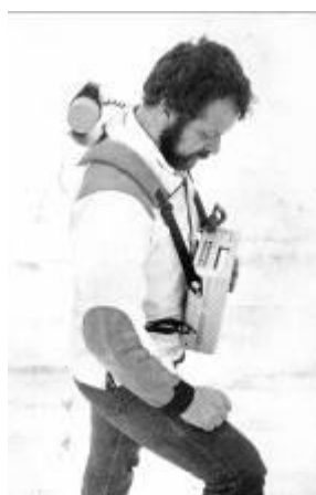
Fig. 4.7 Magnetômetro de precessão nuclear ou precessão de prótons: apresenta precisão de 1nT, dentro da faixa de medidas de 20.000 a 100.000 nT. É muito comum seu uso em levantamentos aéreos e também em levantamentos terrestres. Fonte: Luiz & Silva, 1995.
