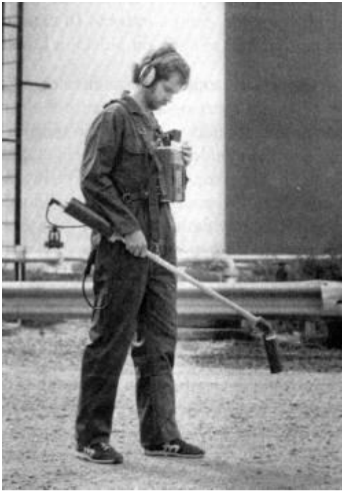
Fig. 4.8 - Magnetômetro de bombeamento óptico: pode medir o campo na presença de elevados gradientes magnéticos, de cerca de 50.000 nT. Devido sua maior sensibilidade é bastante utilizado em levantamentos aéreos. Fonte: Luiz & Silva, 1995.
