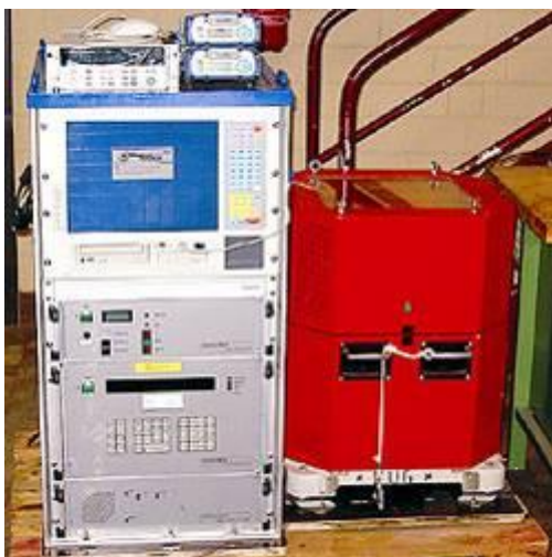
Fig. 3.15 – Gravímetro Shipboard - Sistema KSS31M com receptor GPS, usado em medidas de gravidade na superfície d'água. (Fonte: BGR)
