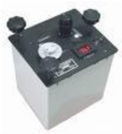
Fig. 3.13 – Gravímetro LaCoste & Römerberg modelo G, de uso comum em levantamentos terrestre. Precisão: 0,01 mgal. (Fonte: http://www.lacosteromberg.com )
