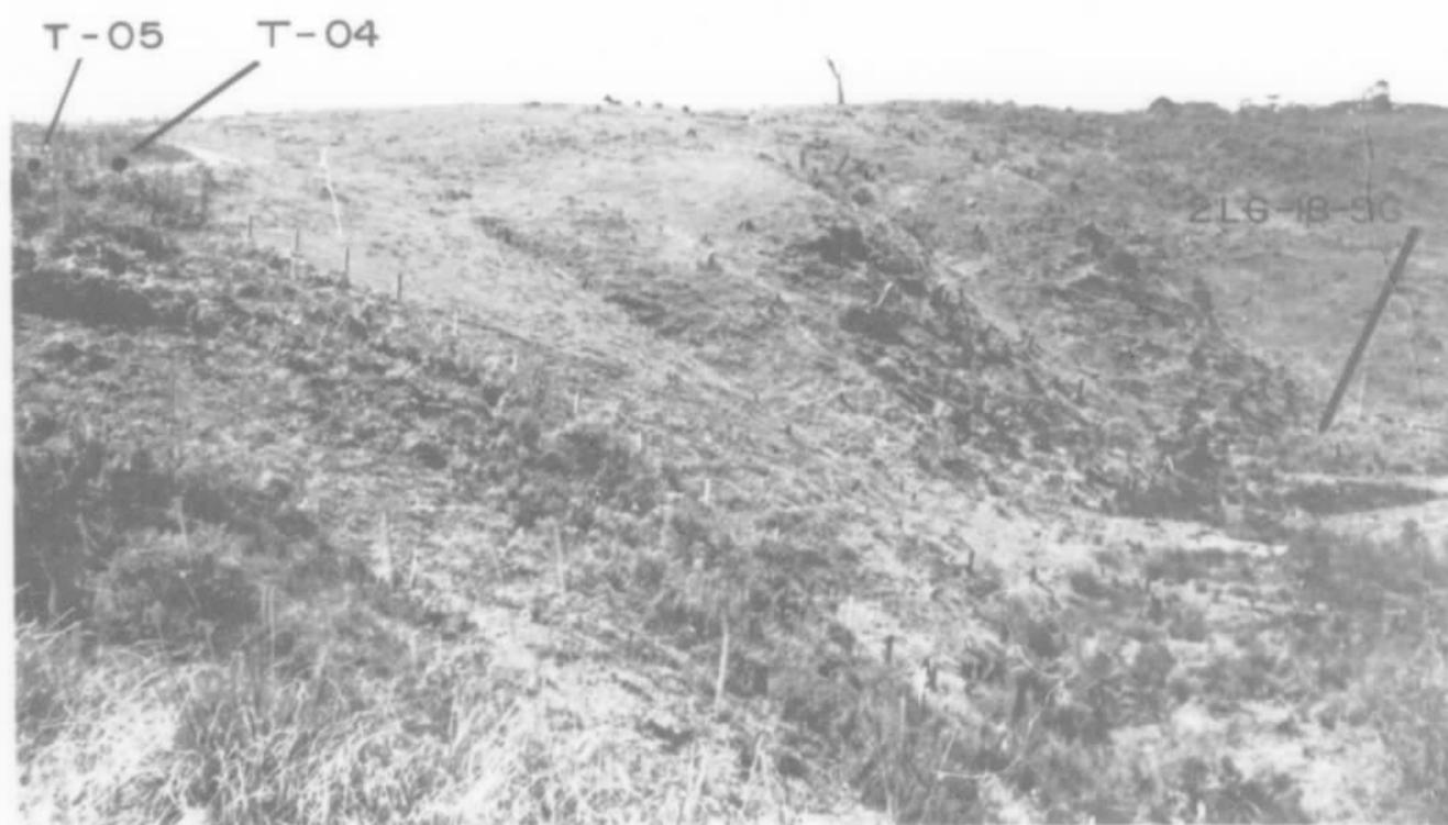
Foto 6 - Escarpa de falha correspondendo ao contato da Formação Rio Bonito com o sub-grupo Itararé. As trincheiras T-04 e T-05 serviram para a locação do furo 2LG-18-SC.
