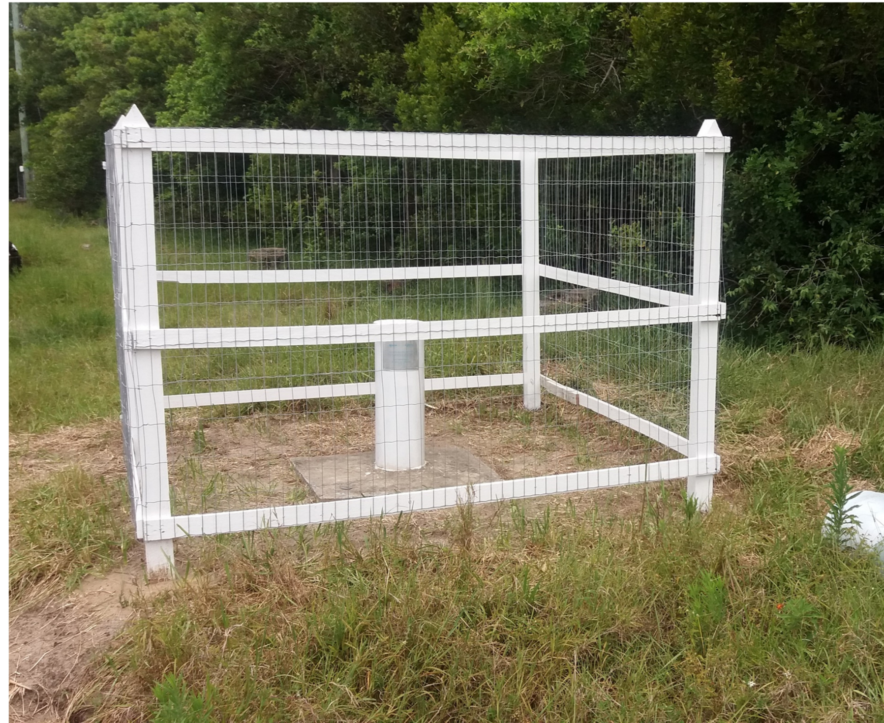
Figura 1. Poço monitorado. Informações sobre este poço constam em http://siagasweb.cprm.gov.br/layout/detalhe.php?ponto=4300020528 .
