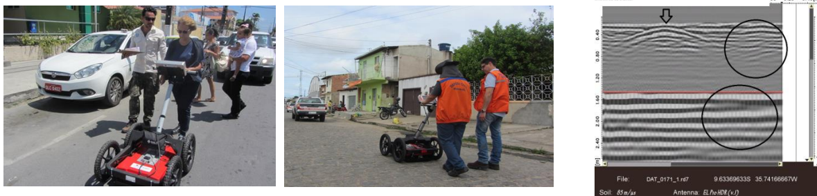
Figura 3 – Levantamento com GPR em ruas do bairro Pinheiro, Maceió-AL.
