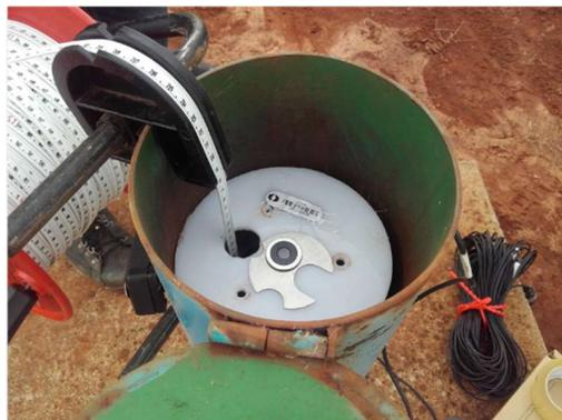
Figura 15: Equipamentos de registro de nível d'água, por pressão, totalmente acondicionado na estrutura do poço.
