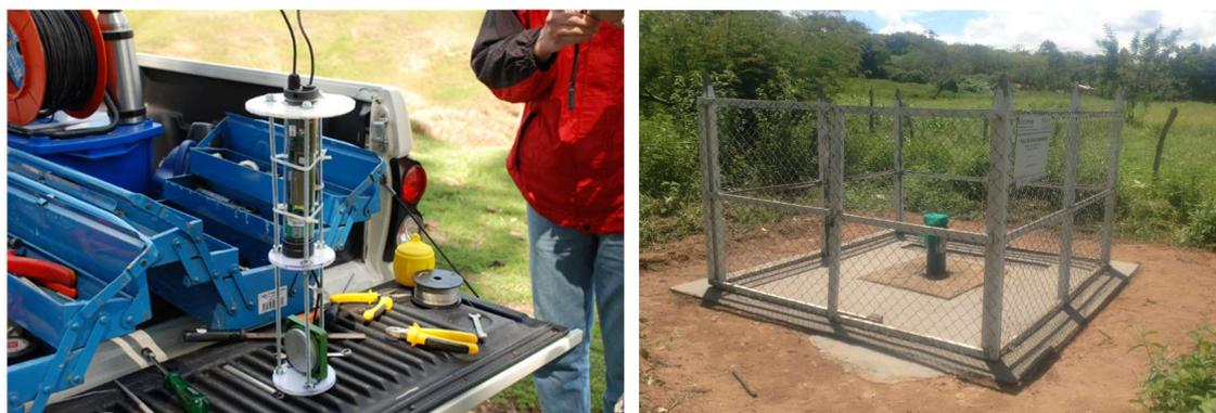
Figura 16: Gaiola de suporte para equipamento de registro de nível por bóia e contra-peso e um dos poços de monitoramento em visão geral.
