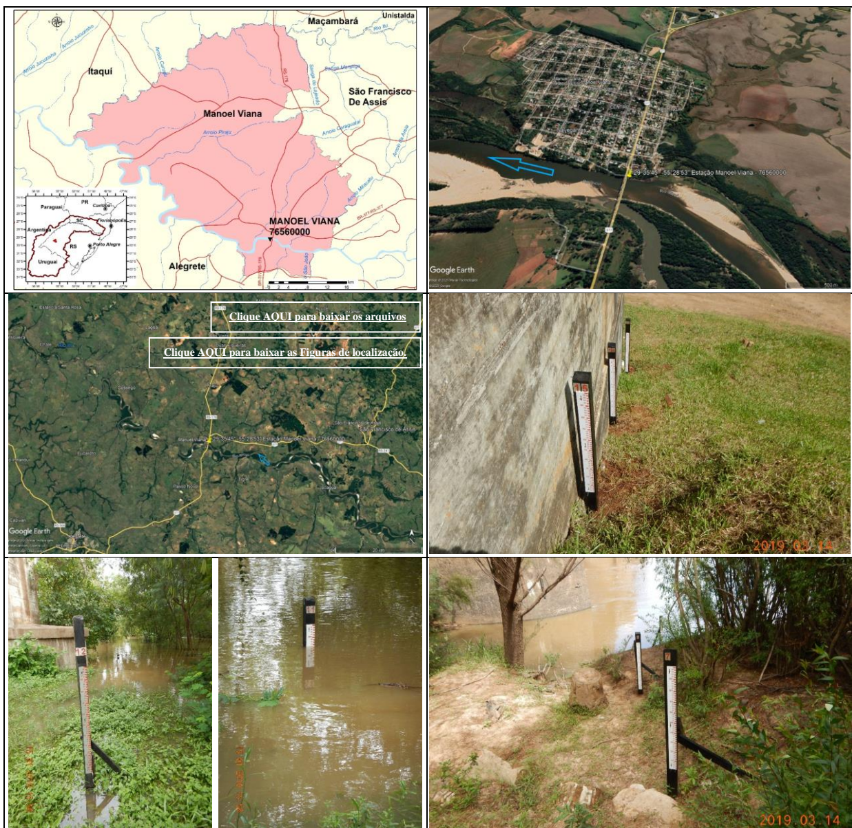
Figura 02 – Localização e fotos da seção de réguas da estação Manoel Viana
