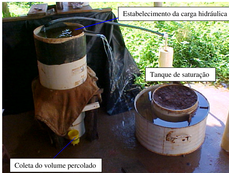
Figura 10 – Saturação dos módulos das colunas de solo e a determinação da condutividade hidráulica do solo saturado pelo método do permeâmetro de carga constante
