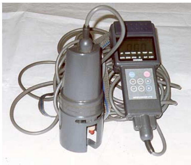
FIGURA 10 HORIBA U10 – equipamento utilizado para medir in loco os parâmetros físico-químicos em amostras de água
