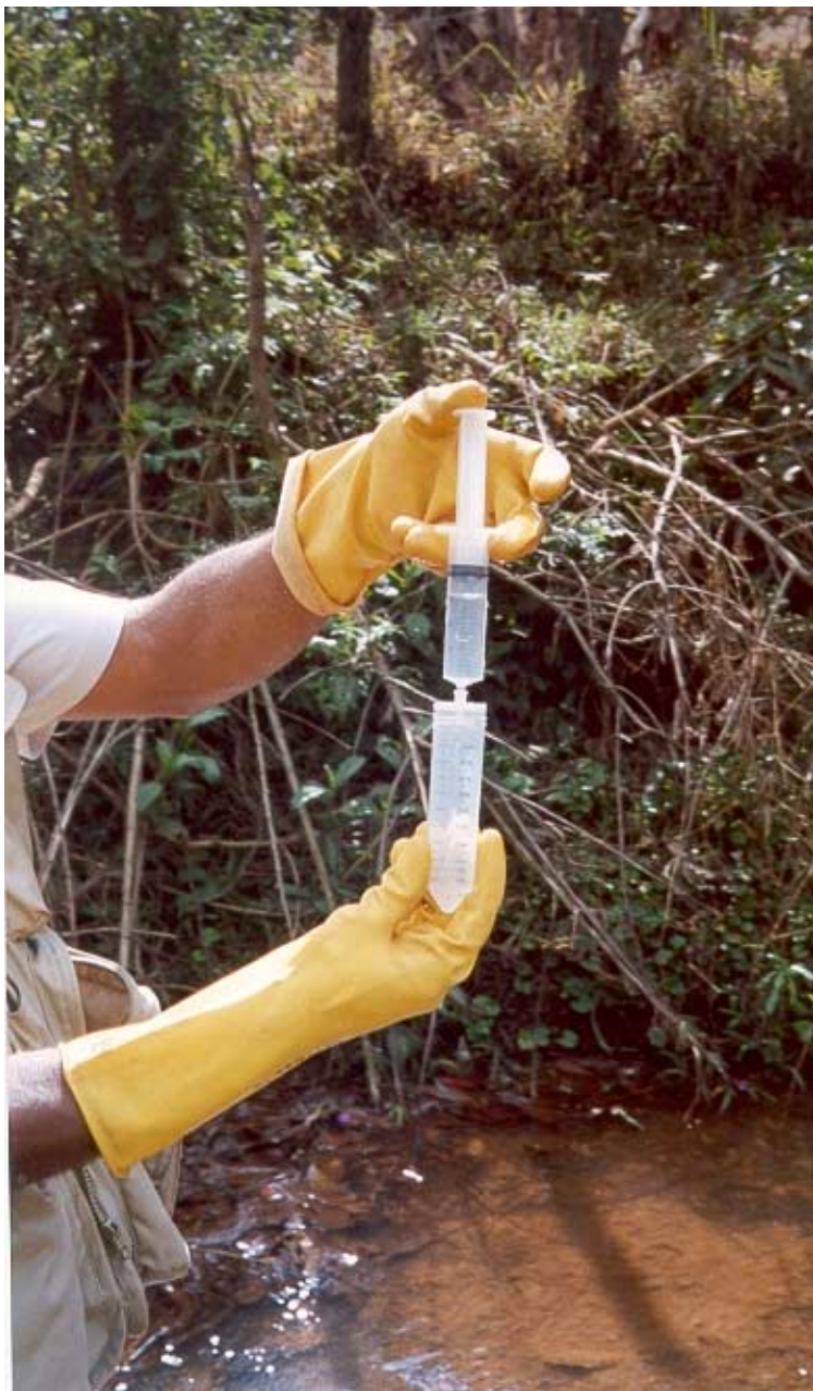
Foto 4: Coleta da amostra de água (observar a posição do filtro entre a seringa e o tubo)
