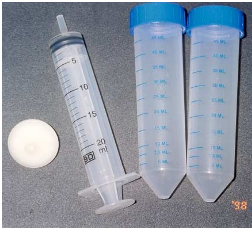
Foto 2: Material para coleta de água em cada ponto: 2 tubos para centrífuga, unidades filtrantes e seringa descartável sem agulha
