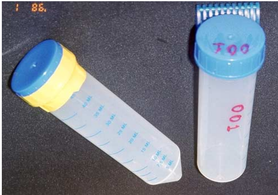
Foto 9: Fita isolante amarela ao redor da tampa para facilitar a identificação da amostra para análise dos ânions
