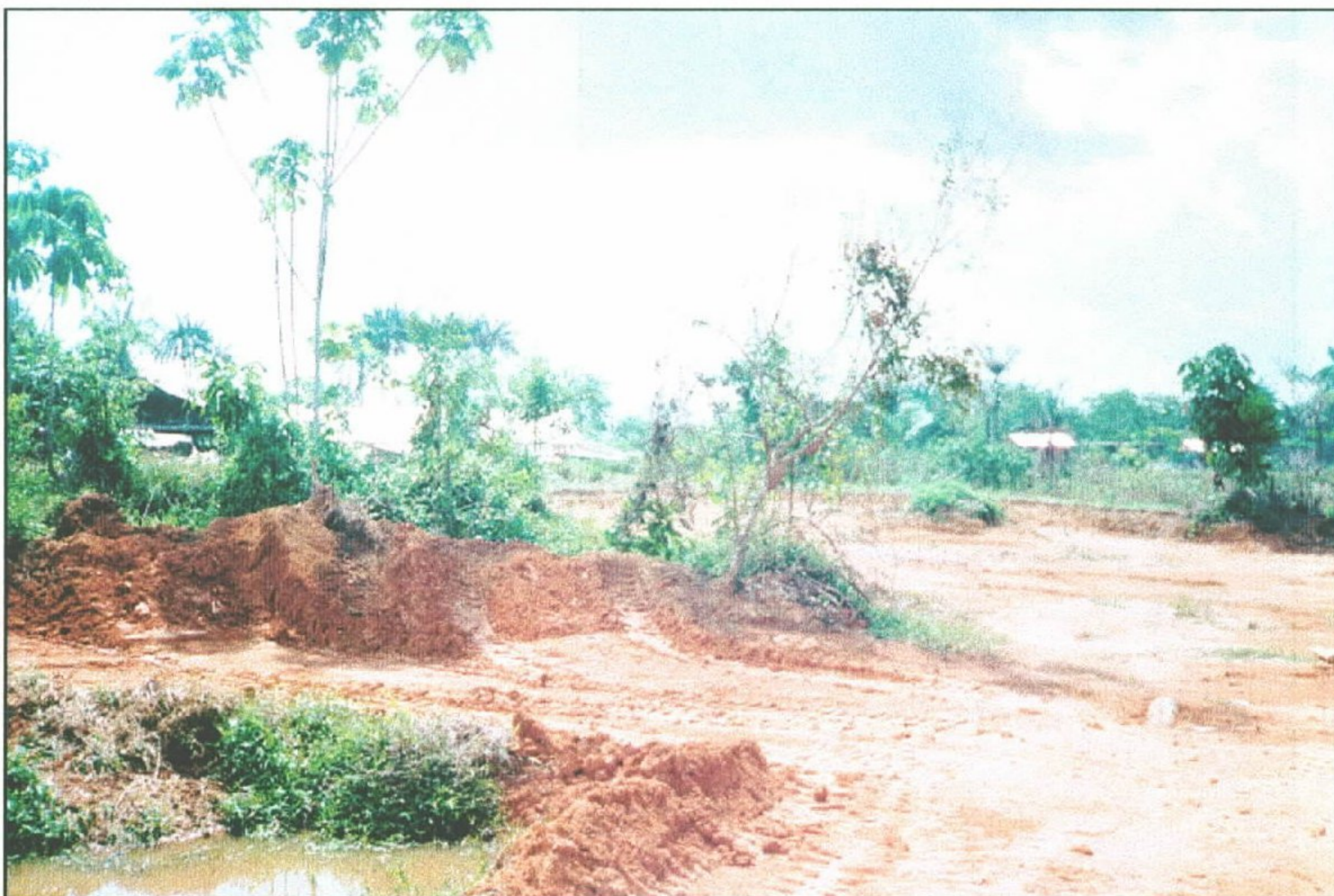
Foto 08 – Local de extração de argila vermelha, para confecção de tijolos. Terraço fluvial nas proximidades da cidade de Tabatinga.
