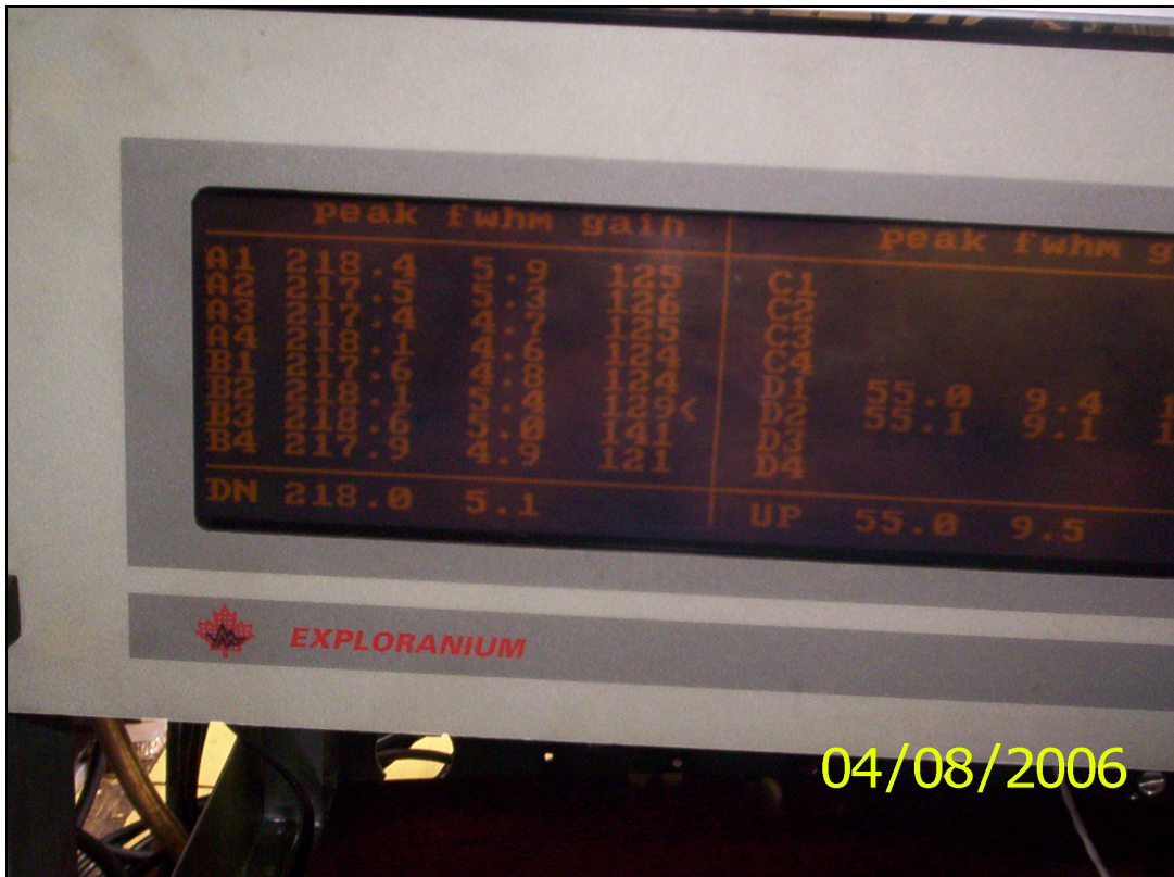
Foto tirada no dia 04/08/2006 no hangar em Jacarepaguá mostrando a resolução dos cristais do sistema Exploranium GR820 da aeronave PR-FAS.
