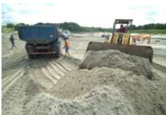
Foto 5.10 - Lavra de areia aluvionar em leito seco do rio Apodi (Mossoró)
