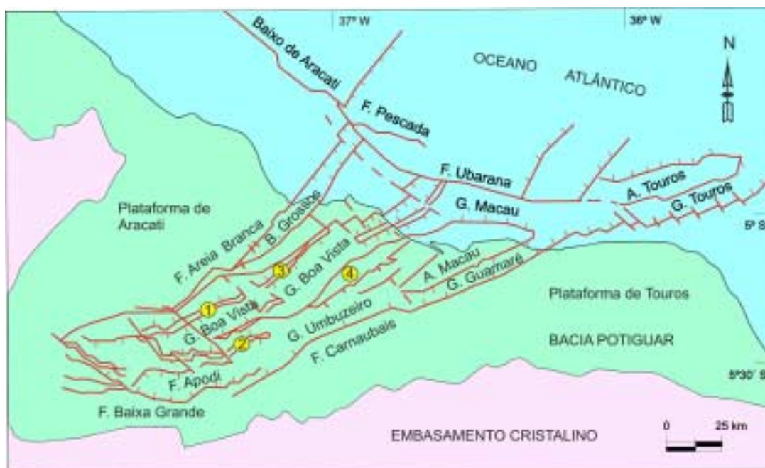
Figura 3.3 - Arcabouço estrutural do rifte Potiguar. (1) Alto dos Canudos, (2) Alto de Quixaba, (3) Alto de Mossoró e (4) Alto da Serra do Carmo. A - alto, B - baixo, G - gráben e F- falha. Amaral (1990), adaptado de Creminini et al. (1996).
