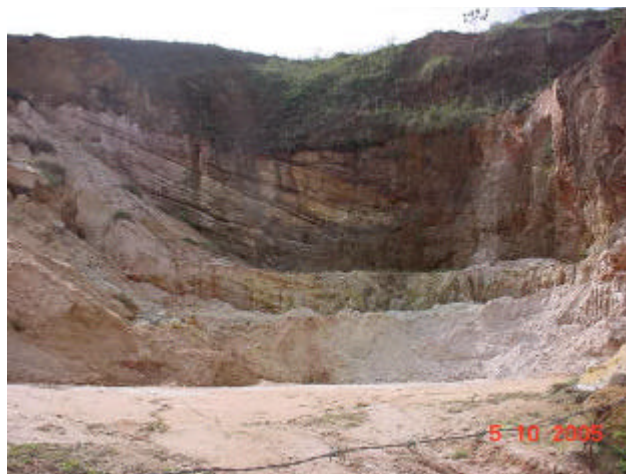
Figura 5.59 a e b: Lugares de extração de material de construção. a. Pedreira nos arredores de Espera Feliz na direção norte. Retira-se brita de várias granulometrias e blocos para a construção civil, revestimento de rios e construção de estradas. b. Quartzito relativamente puro ao norte de Caparaó utilizado para retirar areia e brita fina.
