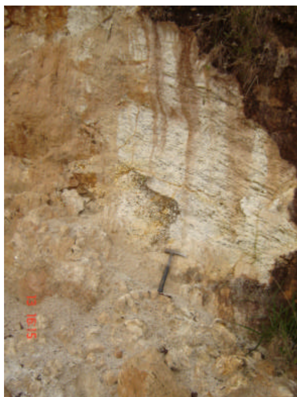
Figura 5.34: Quartzito impuro, intemperizado e mostrando a grande quantidade de micas e caulim orientadas na mesma direção. A direita pode se ver o contato irregular com o gnaiss migmatizado.
