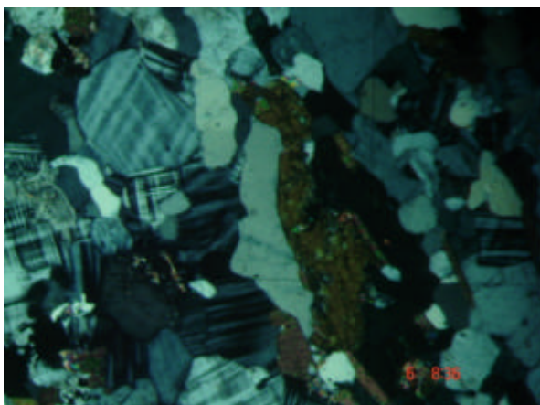
Figura 5.15: Microfotografia do Ortognaisse Serra das Cangalhas. Mica é rica em inclusões de pequenos cristais. Nicois cruzados
