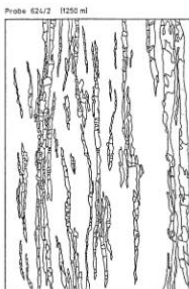
Figura 5.50: O desenho mostra que nesta zona, mais perto da parte central, a separação dos agregados de quartzo óticamente não é mais possível (Fritzer, 1991). Amostra 624/2. Acima é indicada a distância da zona central. Interpretou-se aqui uma faixa mais milonitizada da zona intermediária.
