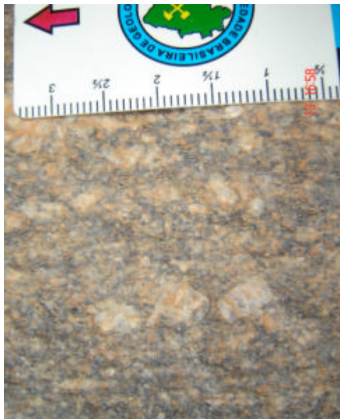
Figura 5.3: Aparência do granito Santa Angélica em afloramento. Possui granulação grossa, formado por feldspatos potássicos grandes, mica, quartzo e pouco anfibólio. Aqui não observa-se allanita.
