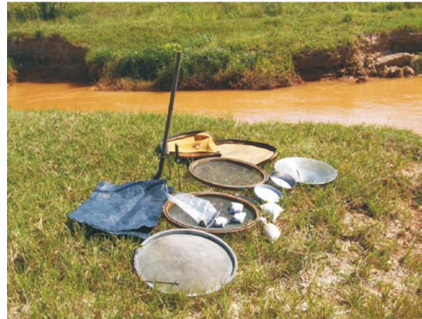
Foto 6.3 - Kit para amostragem e obtenção de concentrados de minerais pesados por bateia
