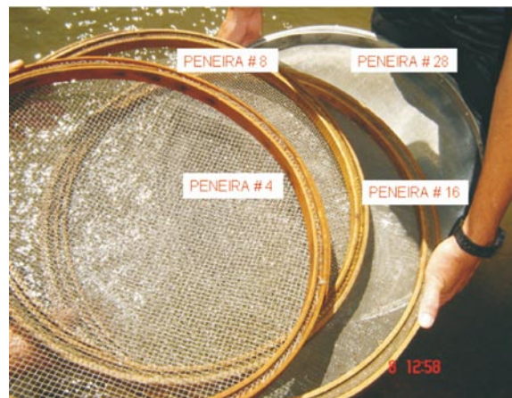
Foto 6.4 - Seqüência de peneiras utilizada na classificação e concentração dos minerais pesados das amostras.
