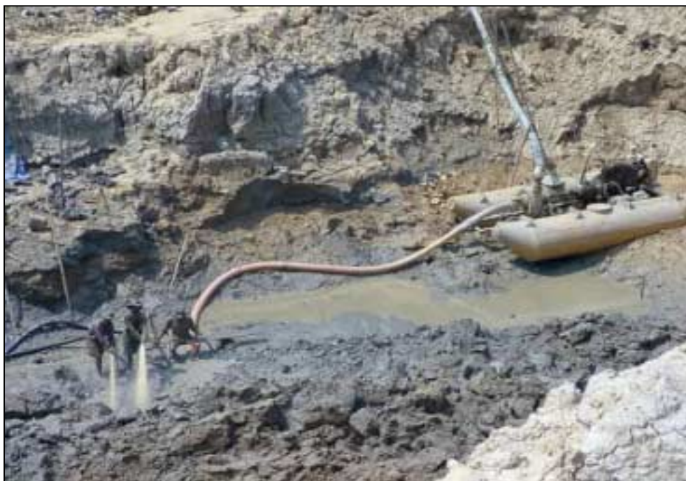
Figura 94 - Detalhe mostrando sedimentos expostos na cava de garimpo de ouro do Taquara em via de desmonte hidráulico (14/09/2004), visando retirada de material estéril, a fim de alcançarem a camada de cascalho aurífero.
