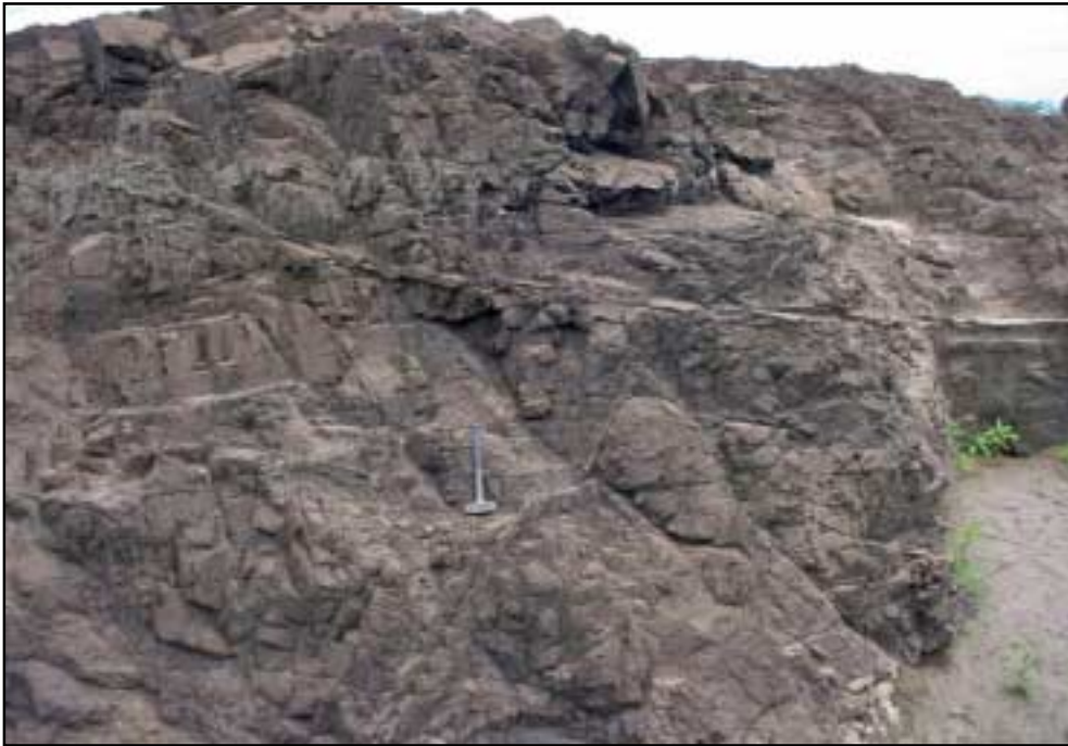
Figura 38 - Detalhe do sistema de fraturas do granito na cachoeira do Jirau (JM-108), onde observam-se fraturas principais de direção N40°E;80°NW, N25°W;60°NE.
