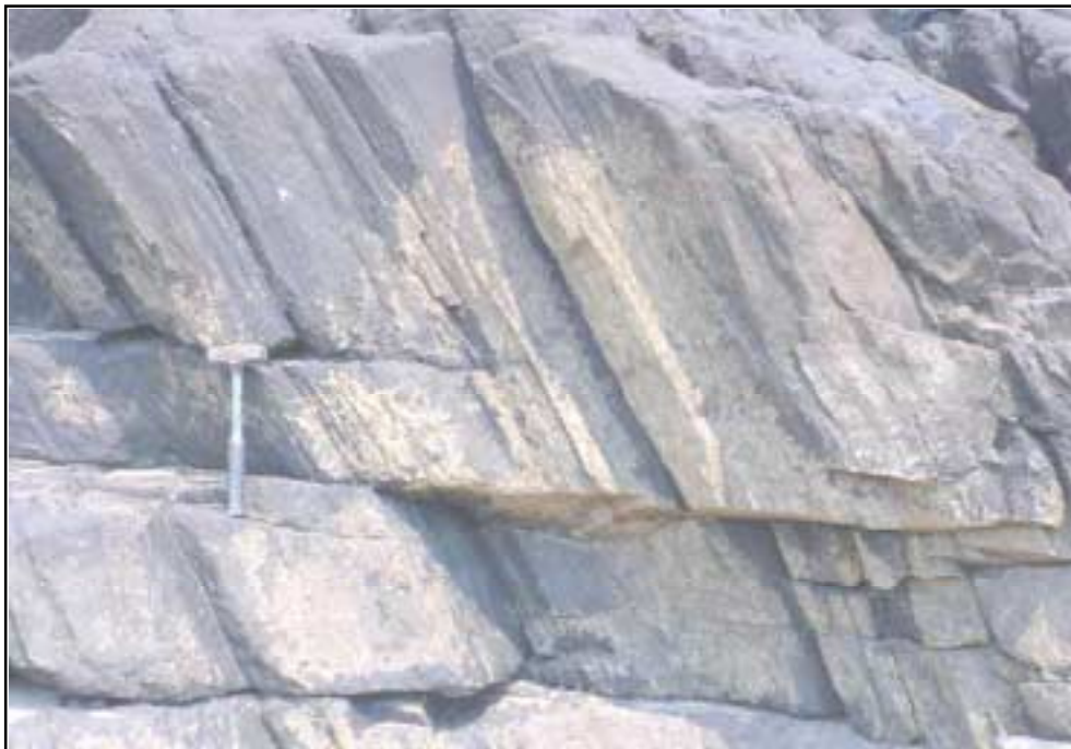
Figura 18 - Quartzito da Formação Mutum-Paraná exibindo alto ângulo de mergulho do plano de foliação metamórfica.
