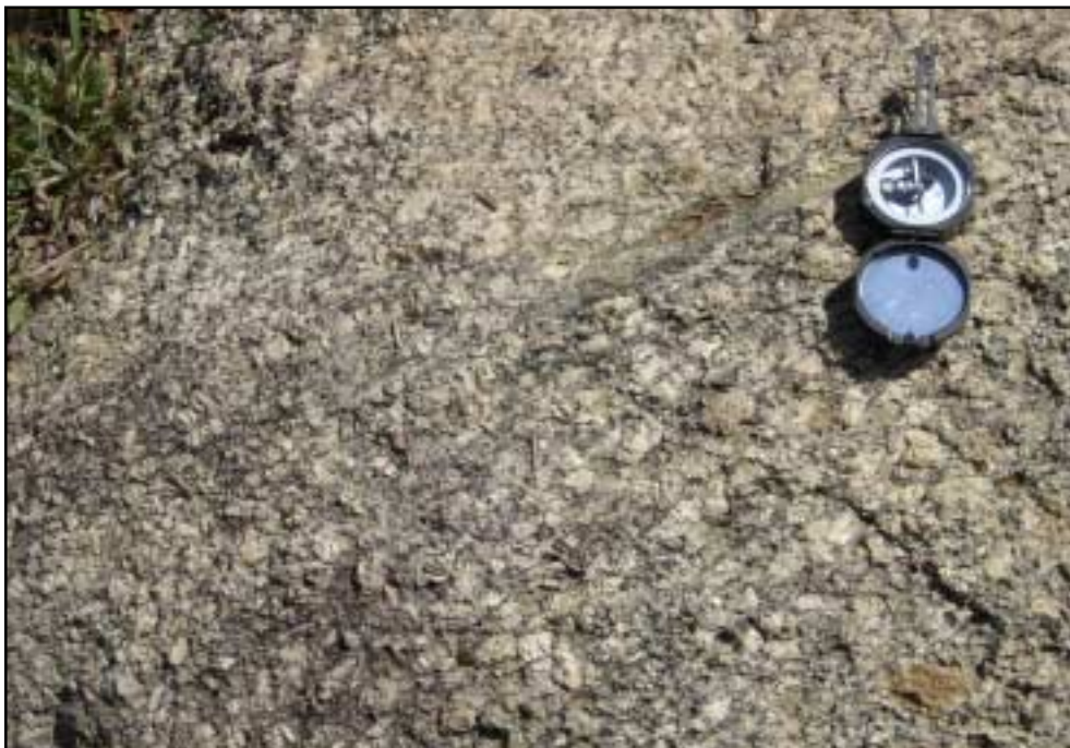
Figura 10 - Granito Porfíritico Alto Candeias apresentando estrutura de fluxo magmático e xenólitos de paraderivadas da Suíte Metamórfica Nova Mamoré (JM-339).
