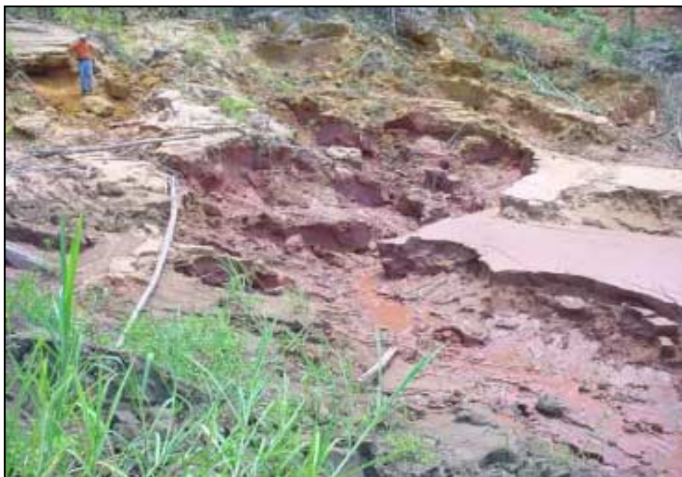
Figura 110 - Afloramento do Ponto JG-95. Voçorocamento do barranco do rio Madeira, com fluxo de detritos (solifluxão) em direção ao corpo de água do rio.
