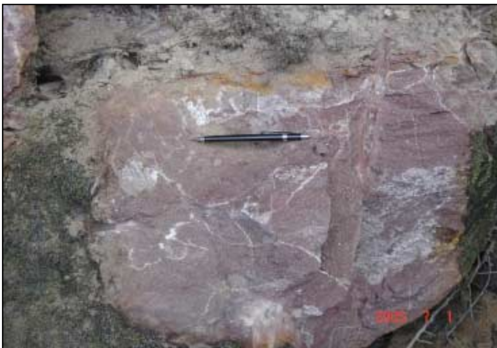
Figura 17 - Afloramento de Arenito Arcosiano da Formação Palmeiral (JM-316) apresentando fraturas preenchidas por material caulínico, localizado na margem do rio Jaci-Paraná (AID).
