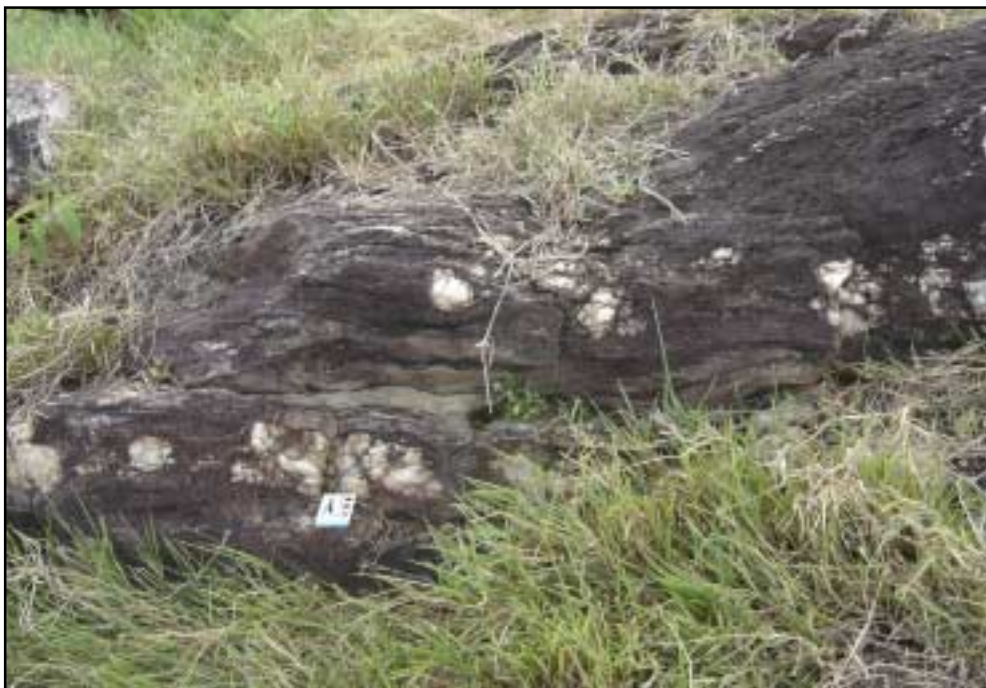
Figura 5 - Paragnaisse mostrando bolsões de quartzo envolvidos pela foliação metamórfica de atitude N 80° E/47° NW.
