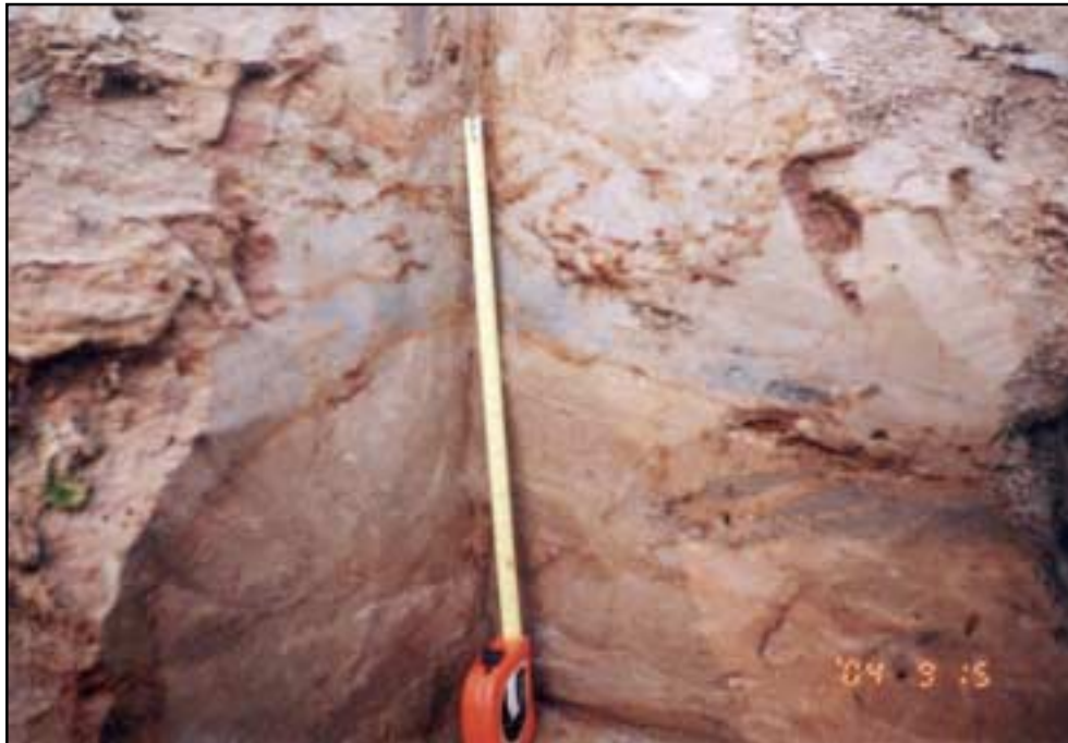
Figura 3.3 - Sedimentos areno-argilosos da Formação Jaciparaná, que compõem o sistema aquífero intergranular descontínuo livre.
