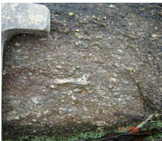
Figura 5.20: Aparência típica do Ortognaisse Estrela. Cristais maiores de feldspato mostram nítida orientação.
