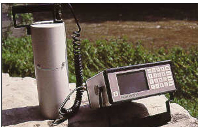
Figura 1 – Gamaespectrômetro Portátil EXPLORANIUM GR-320.
