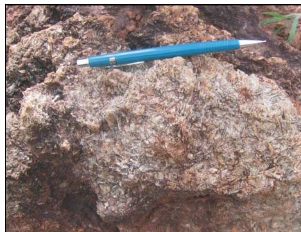
Figura 6.3: Aspecto macroscópico do cianitito na mina de cianita, na Fazenda Cianita. Destaque para isotropia da rocha com cristais de cianita diablásticos (Joffily, 2006).
