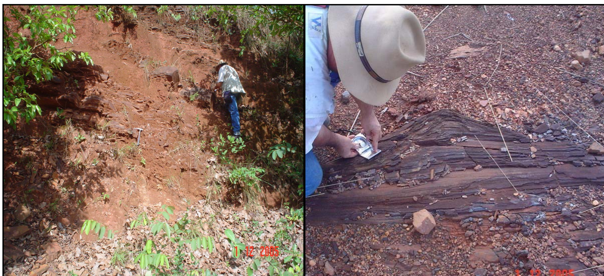
Figura 3.9: a) Camada métrica de formação ferrífera bandada intercalada em saprolito de xisto. b) formação ferrífera em leito de estrada.
