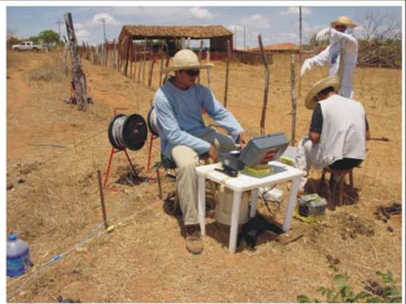
Detalhe do centro da Sondagem Elétrica Vertical 01, com linha AB de 2000 metros. Equipamento utilizado corresponde a um Eletrorresistivímetro PER-500, fabricado pela DPM engenharia.
