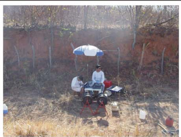
Detalhe do centro da SEV 08, exibindo as bobinas referentes aos eletrodos AB e MN, o equipamento e outros objetos utilizados nas sondagens.
