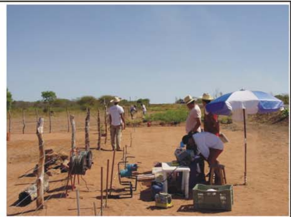
Sondagem Elétrica Vertical 02.
