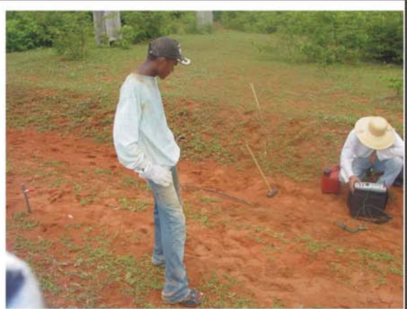
Trecho do Perfil de Resistividade IJ, realizado sem automóvel, correspondente as últimas estações.
