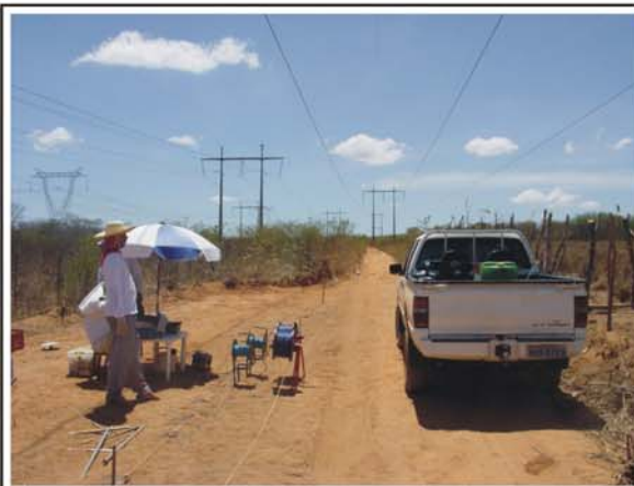
Sondagem Elétrica Vertical 09, realizada na estrada da rede elétrica de alta tensão de Paulo Afonso.
