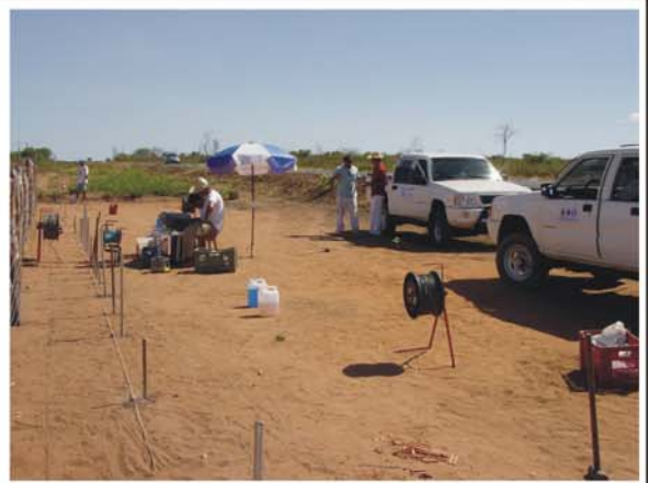
Sondagem Elétrica Vertical 02, realizada na rodovia entre as cidades de Barbalha e Missão Velha.
