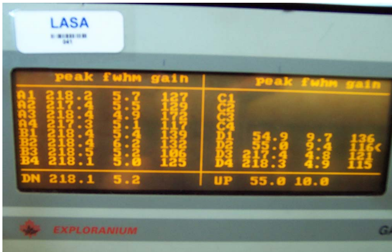
Foto tirada no dia 02/10/2007 no hangar em Jacarepaguá mostrando a resolução dos cristais do sistema Exploranium GR820 da aeronave PR-FAS
