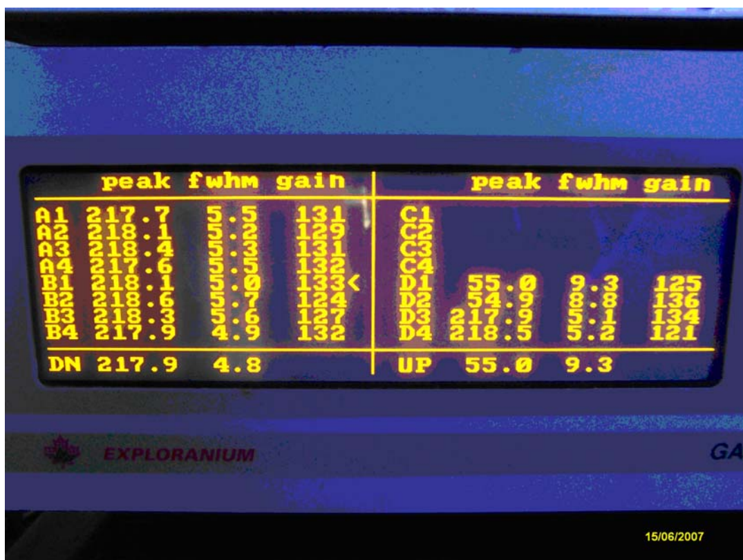
Foto tirada no dia 15/06/2007 no hangar em Jacarepaguá mostrando a resolução dos cristais do sistema Exploranium GR820 da aeronave PT-WOT.
