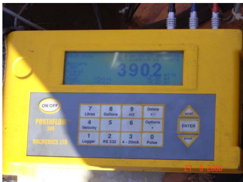
Foto 1.16 - Vazão de 390,2 m 3 /h mostrada no visor do “datalogger” programado para registrar a descarga a intervalos de 1 minuto, no teste da Faz. COBA.
