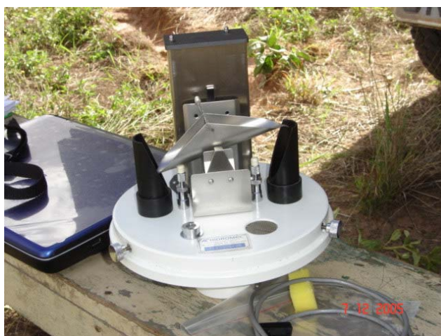
Foto 1.6. Detalhe do pluviógrafo instalado
