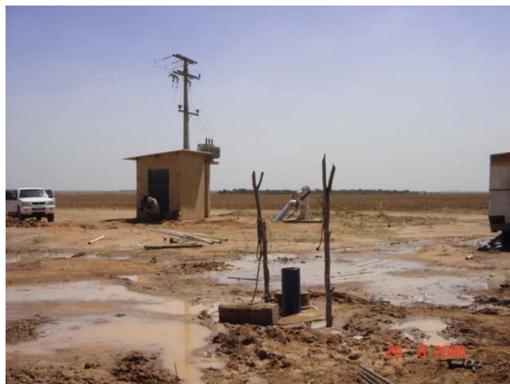
Foto 1.14 – Vista do poço bombeado e do poço de observação PO33 situado a 22 m de distância, no teste de aquífero realizado na Faz. COBA.
