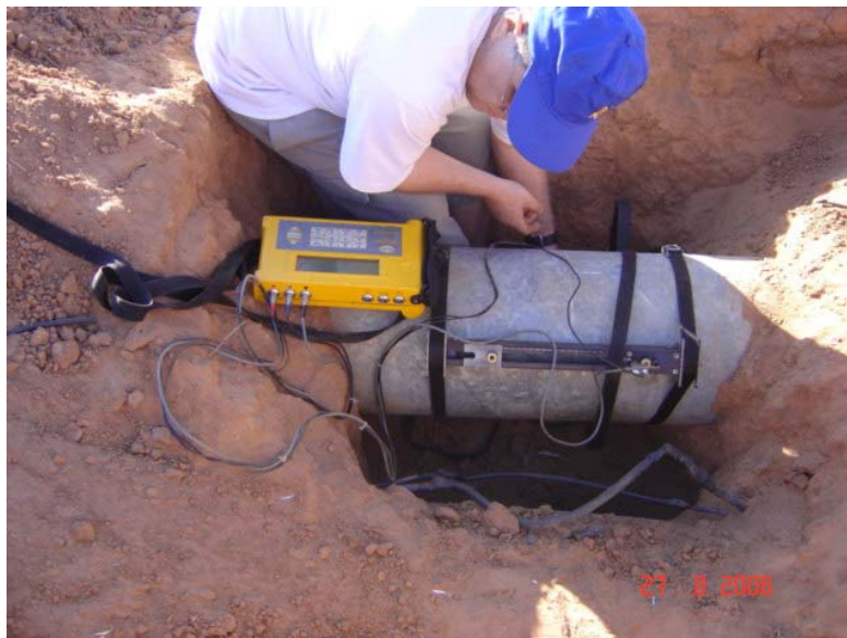
Foto 1.15 – Ilustração da instalação do equipamento de ultra-som no tubo de descarga da vazão bombeada no teste de aquífero da Faz. COBA.
