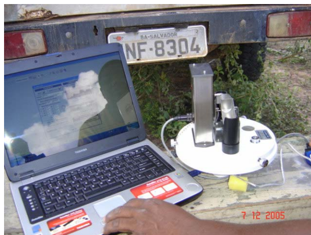
Foto 1.7. Aferição do pluviógrafo antes da instalação
