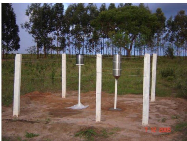
Foto 1.5. Pluviógrafo instalado (digital) tendo ao lado um pluviômetro (manual), localizado na Fazenda Tropeiro Velho.
