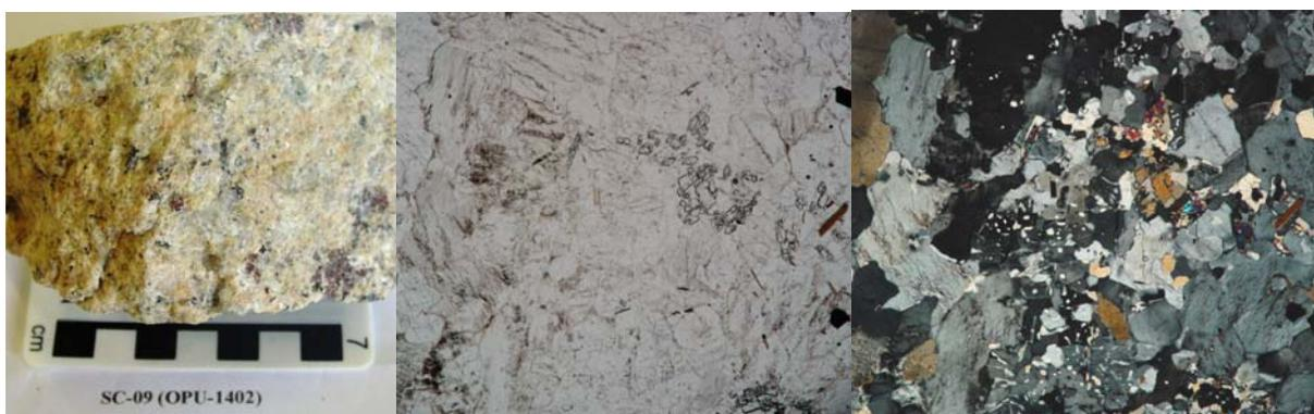
**Figura 23:** Foto de fragmento da amostra SC-09, leucogranito G3, mostrando cristais de granada vermelha na matriz leucocrática. As fotomicrografias destacam a matriz quartzo-feldspática com pequenos cristais de sillimanita prismática e a textura ígnea da rocha, livre de qualquer orientação e deformação.
