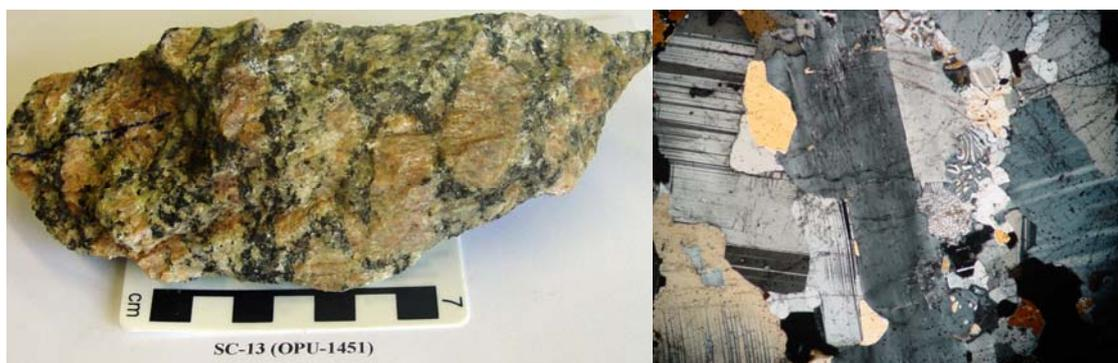
**Figura 24:** Foto de fragmento da amostra SC-13, hornblenda-biotita granito da Suíte Aimorés, mostrando fenocristais de feldspato potássico na matriz mesocrática. A fotomicrografia destaca a textura ígnea da rocha, livre de deformação.
