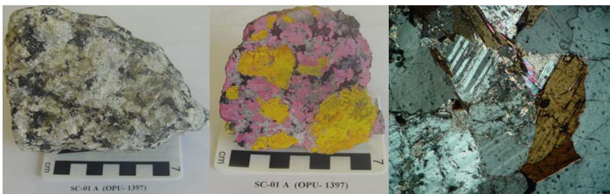
**Figura 25:** Fotos de fragmentos da amostra SC-01A, um biotita granito da intrusão de Barra do São Francisco, Suíte Aimorés, mostrando fenocristais de feldspato potássico que, na foto central, estão tratados por colorimetria para distinção de feldspatos (amarelo = feldspato potássico, rosa = plagioclásio). A fotomicrografia destaca a textura ígnea da rocha, livre de deformação.
