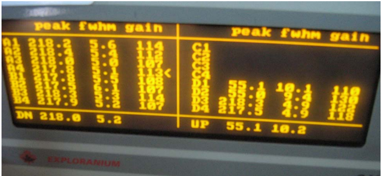
Foto tirada no dia 27/06/2008 no hangar em Jacarepaguá mostrando a resolução dos cristais do sistema Exploranium GR820 da aeronave PT-MEP
