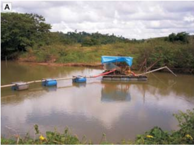
Figura 7.9. Extração de areia no leito ativo do rio São José: (a) draga; (b) área de deposição do material.
