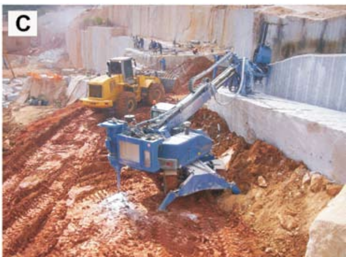
Figura 7.18. Tecnologias de corte: a) flame jet ; b) fio diamantado; c) perfuratriz hidráulica operando em lavra de leucogranito (Mineração Sabadini).
