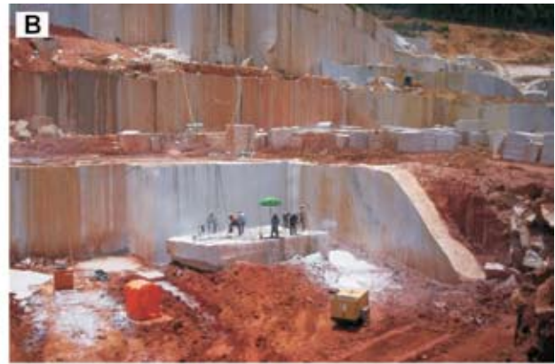
Figura 7.13. Pedreira Categran/Sabadini: a) Frente de lavra; b) Detalhe da foto anterior, mostrando esquadramento de prancha (pedreira Categran/Sabadini).
