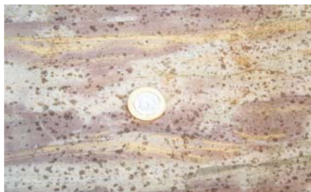
Foto 42 – Calcilitito amarelado a avermelhado com intercalações de finos níveis pelíticos. Descolorações esbranquiçadas. Unidade: NP2spl - Formação Sete Lagoas, Membro Pedro Leopoldo - Local: Pedreira Sambra, Sete Lagoas, a 67,7 m da base. Estação: MP-219 - UTM: 565204/7851764
