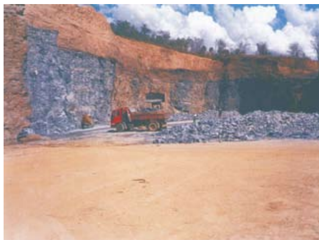
Foto 150 - Pedreira em atividade, mostrando na base, calcário da Formação Lagoa do Jacaré, e no topo, siltito com níveis de arenito da Formação Serra da Saudade. Local: Britador de Abaeté Estação: NS-01 - UTM:449472/7883192
