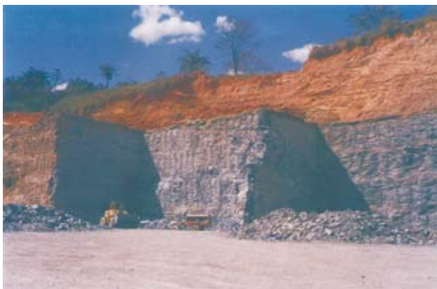
Foto 68 – Contato entre o calcário da Formação Lagoa do Jacaré (base) e siltito com níveis de arenito da Formação Serra da Saudade (topo). Unidade: NP2lj/NP2ss Local: Pedreira da Faz. Bandeira. Estação: NS-001 - UTM: 449472/7883192
