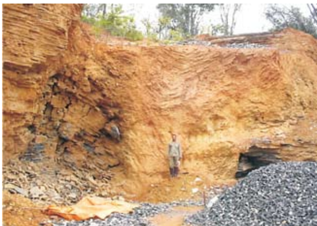
Foto 147: Pedreira rudimentar de calcário preto da Fm. Sete Lagoas para produção de "pedra portuguesa" para calçamento. Local: Fazenda Laguna. Estação: WL-397 - UTM: 547902/7865840
