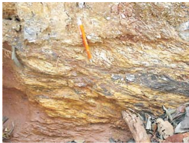
Foto 126: Dobras isoclinais recumbentes formadas no processo de nucleação de rampas durante o deslizamento interestratal. Estação: JM-147 - UTM: 626937/7827639
