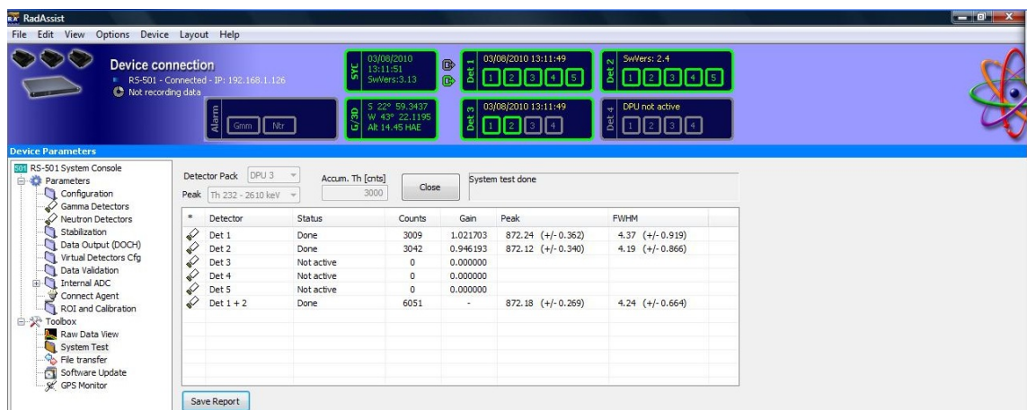
Arquivo (formato *.jpg) gravado no dia 08/03/10 no hangar em Jacarepaguá-RJ mostrando a resolução dos cristais do sistema Radiation Solutions RS-500 da aeronave PR-PEC (Caixa C).
