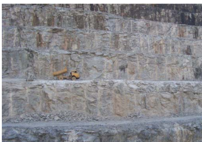
Foto 9.1 – Pedreira de Gnaisse Fernão Dias (folha Campo Belo), ponto JC 1262, donde é extraído material para construção civil (cascalhos, britas e saibro).
