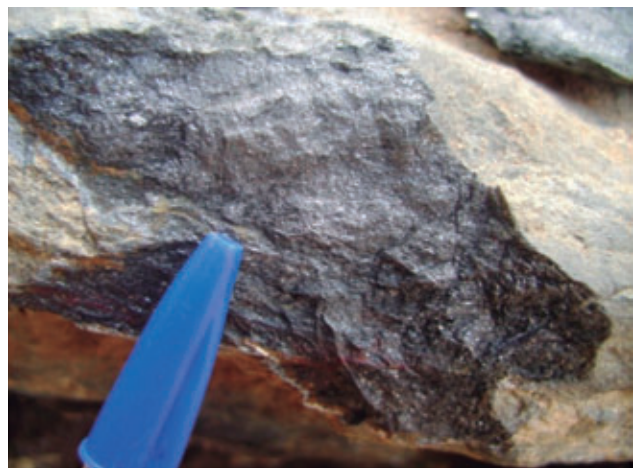
Foto 8.2 – Detalhe da hematita associada à grafita encontrada na forma de blocos extraídos na localidade de Gruguxi ponto MR 097.
