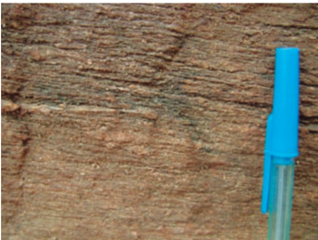
Foto 4.4 – Foliação milonítica em ortognaisse em corte com cristais cominuídos e estirados segundo o eixo de maior “strain” no ponto de afloramento MR 150. Atitude 255°Az/27° NW.
