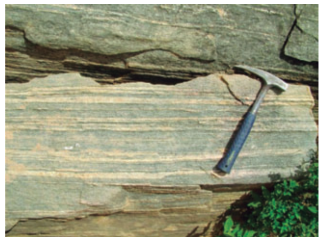
Foto 4.1 – Bandamento gnáissico em ortognaisse, em planta, no ponto de afloramento MR 544. Atitude 355°Az/36° ENE.
