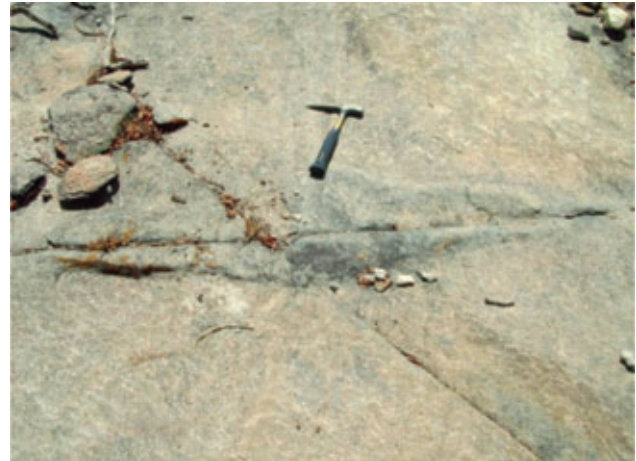
Foto 4.13 – Par de juntas conjugadas de cisalhamento, subverticais, em planta, em afloramento granítico no ponto MR 032. Atitudes 305^\circ Az e 240^\circ Az.
