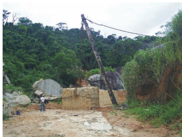
Figura 7.8 – Extração de blocos para corte e polimento em chapas, município de Campos dos Goytacazes, RJ
