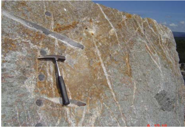
Foto 6.9 – Detalhe da rocha subvulcânica fortemente hidrotermalizada, com enxames de veios de quartzo e disseminações de sulfetos, com magnetita associada, em Canabravinha.
