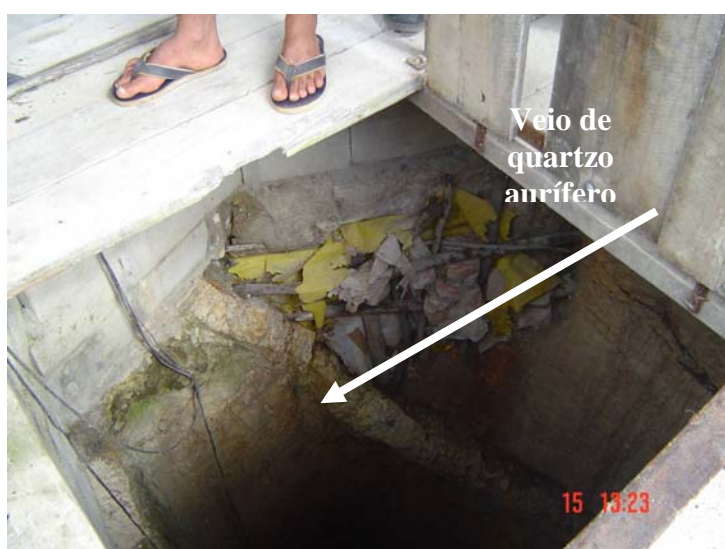
Foto 6.2 – Detalhe do veio de quartzo aurífero na abertura de um poço no garimpo Fazenda do Engenho
