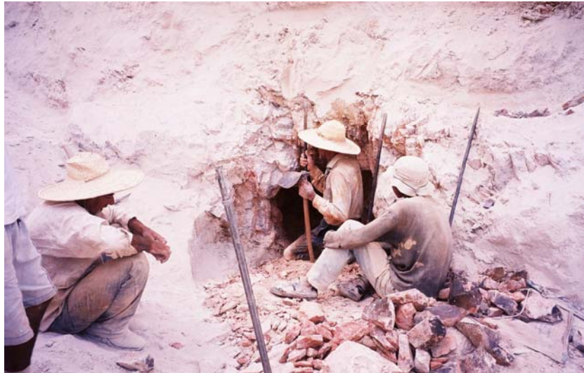
Foto 5.9 - Garimpo de Ponte Alta. Observar o processo de hidrotermalização da rocha vulcânica, que se encontra argilizada e caulinizada.
