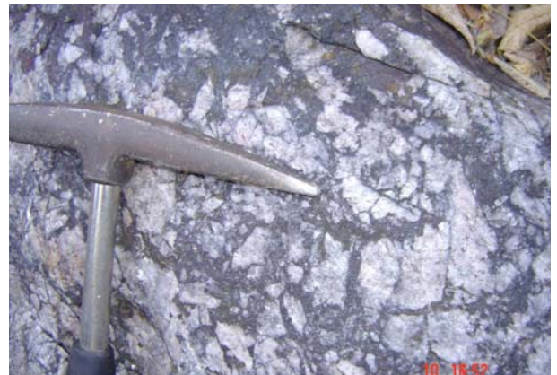
Foto 6.12 – Brecha hidrotermal (quartzo + hematita) na fazenda Salinas. Presença de disseminações de calcopirita e bornita, com ouro subordinado.
