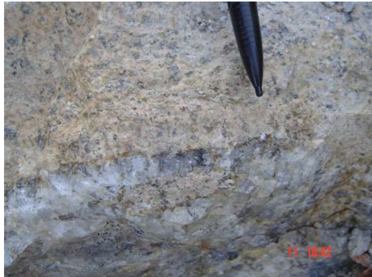
Foto 6.6 – Detalhe da rocha vulcânica cisalhada, fortemente K-feldspatizada e injetada por veios de quartzo.
