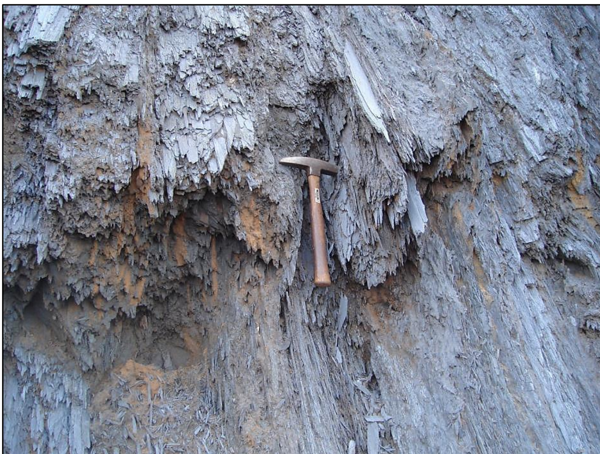
Figura 6.16 – Formação de estruturas em lápis devido ao alto grau de deformação.
